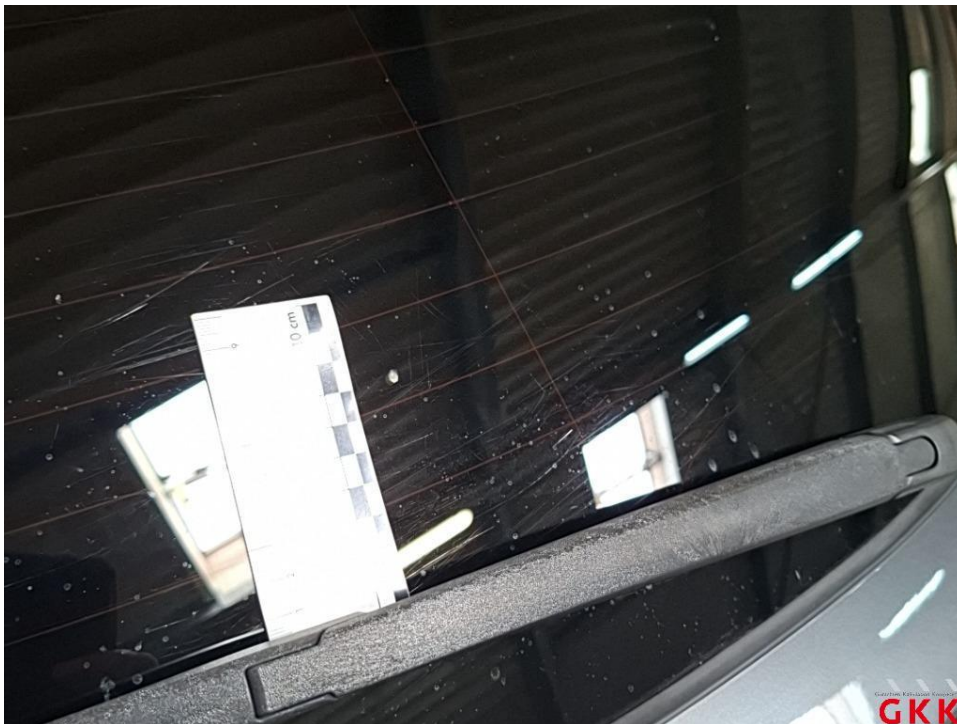
Bild 26 Heckscheibe, verkratzt, ersetzen
