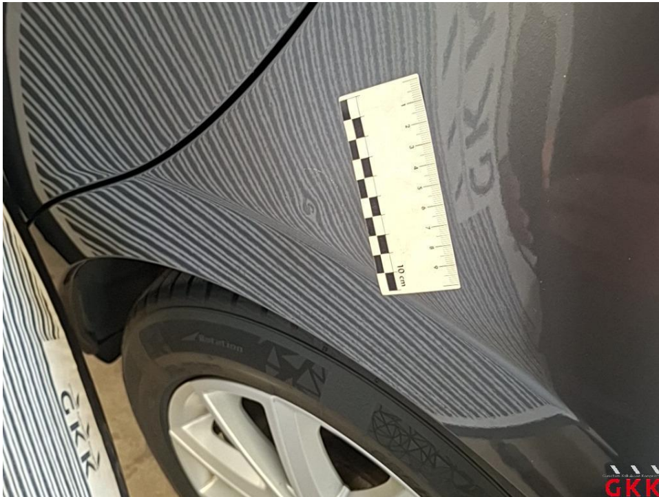
Bild 25 Seitenwand links, beschädigt, kalt drücken
