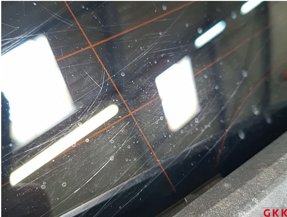
Bild 27 Heckscheibe, verkratzt, ersetzen
