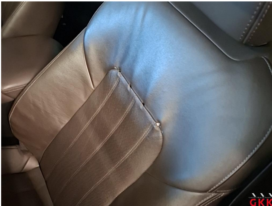
Bild 22 Sitz vorne links, Bezug Rückenlehne -Leder-, beschädigt, ersetzen
