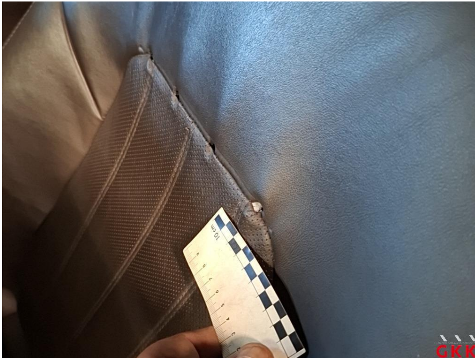
Bild 23 Sitz vorne links, Bezug Rückenlehne -Leder-, beschädigt, ersetzen
