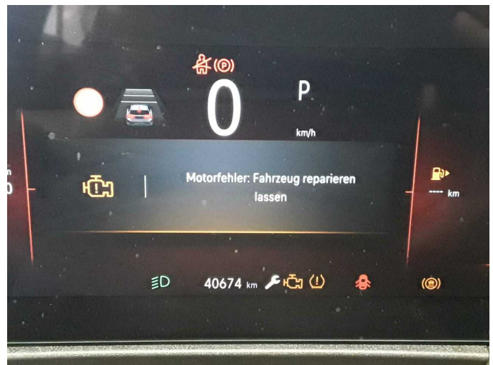
Damage 3: Instrument panel: Indicator light (Motorkontrolle, nicht fahrbereit) - on - Perform diagnosis
