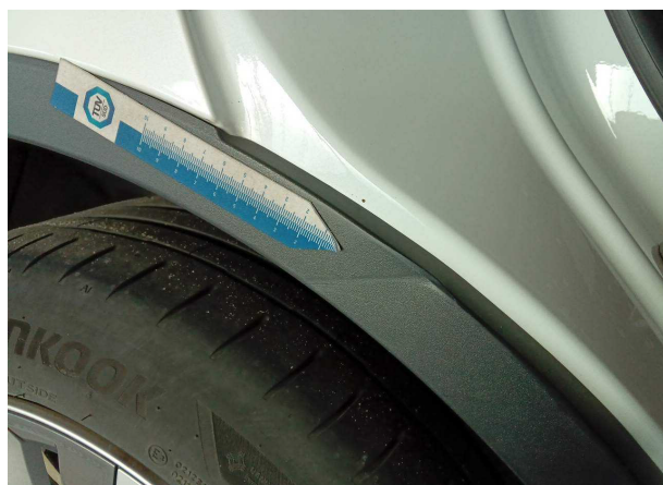
Beschädigung #3: Seitenwand rechts: Radhausverbreiterung - beschädigt - erneuern
