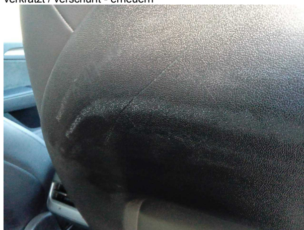
Beschädigung #8: Sitz vorn: Sitzkastenverkleidung rechts - verkratzt / verschürft - erneuern
