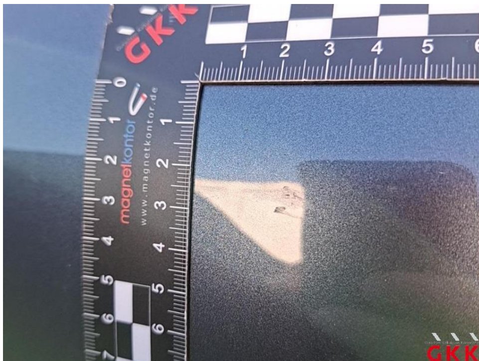
Bild 28. Tür vorne rechts, bis 3 Dellen / Bauteil, Smartrepair
