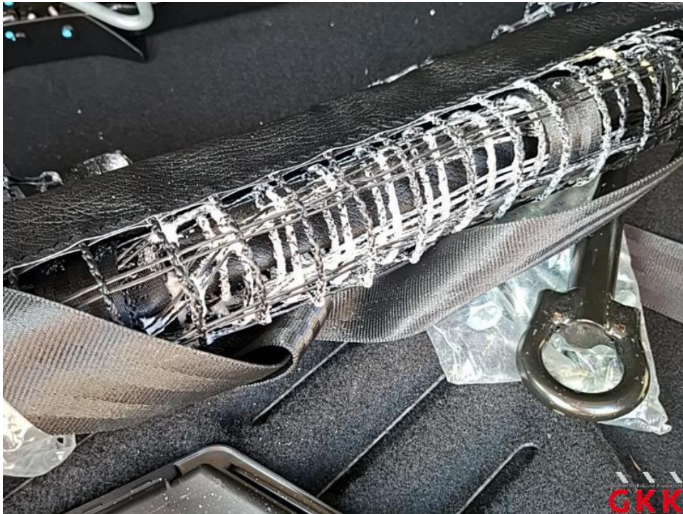
Bild 18. Laderaum, Trennnetz, beschädigt, ersetzen
