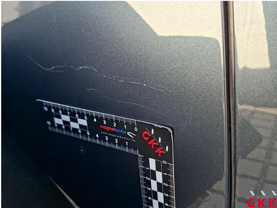
Bild 32. Tür hinten rechts, verkratzt, lackieren
