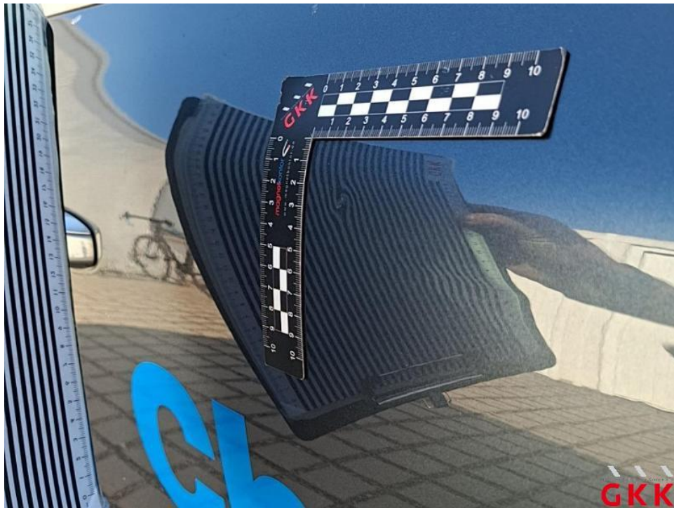
Bild 27. Tür vorne rechts, bis 3 Dellen / Bauteil, Smartrepair
