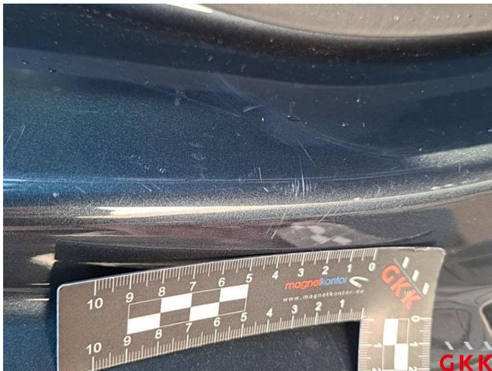
Bild 35. Tür hinten rechts, Einstieg, verkratzt, Smartrepair
