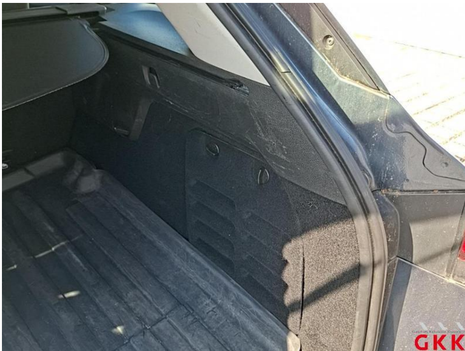
Bild 44. Seitenwand rechts, Innenverkleidung, verkratzt, Smartrepair
