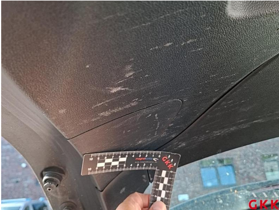
Bild 47. Heckklappe, Innenverkleidung, verkratzt, ersetzen
