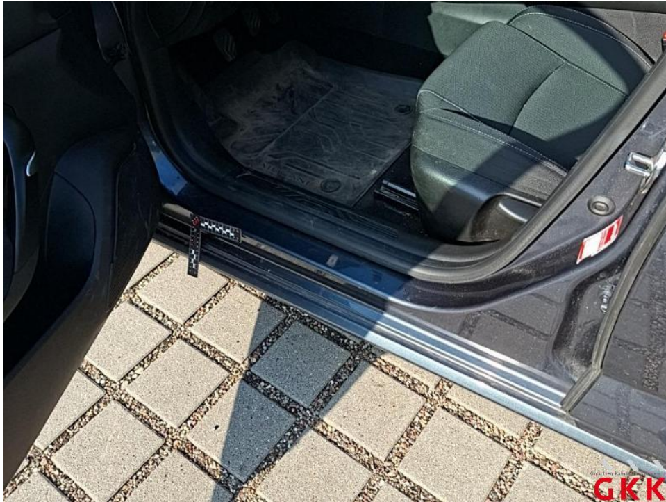
Bild 59. Tür vorne links, Einstieg, verkratzt, Smartrepair
