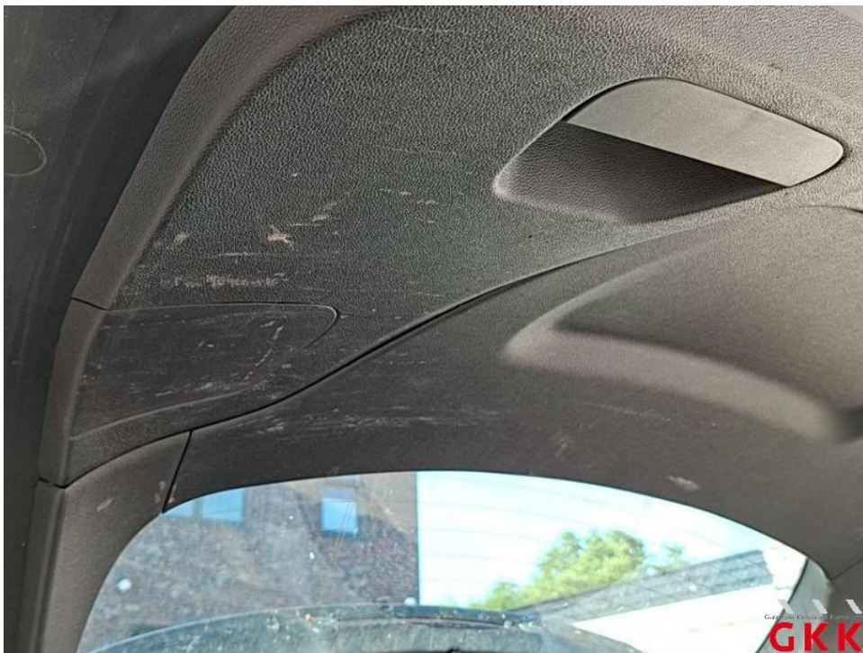
Bild 46. Heckklappe, Innenverkleidung, verkratzt, ersetzen
