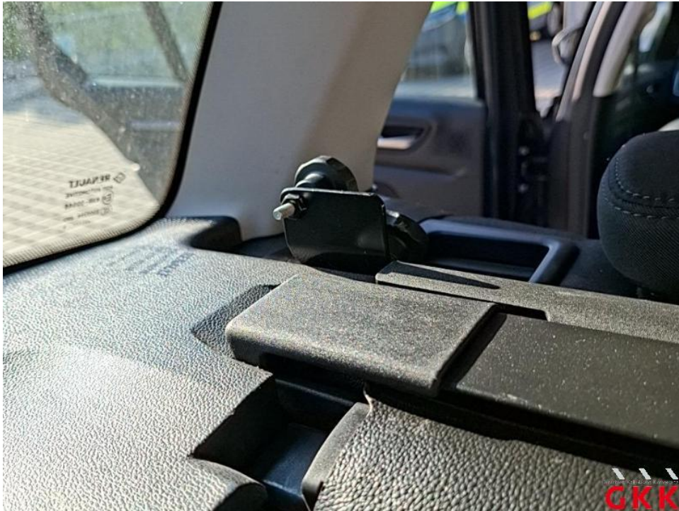
Bild 13. UTC_Trenngitter inkl. Einbau_Megane, fehlt, ersetzen
