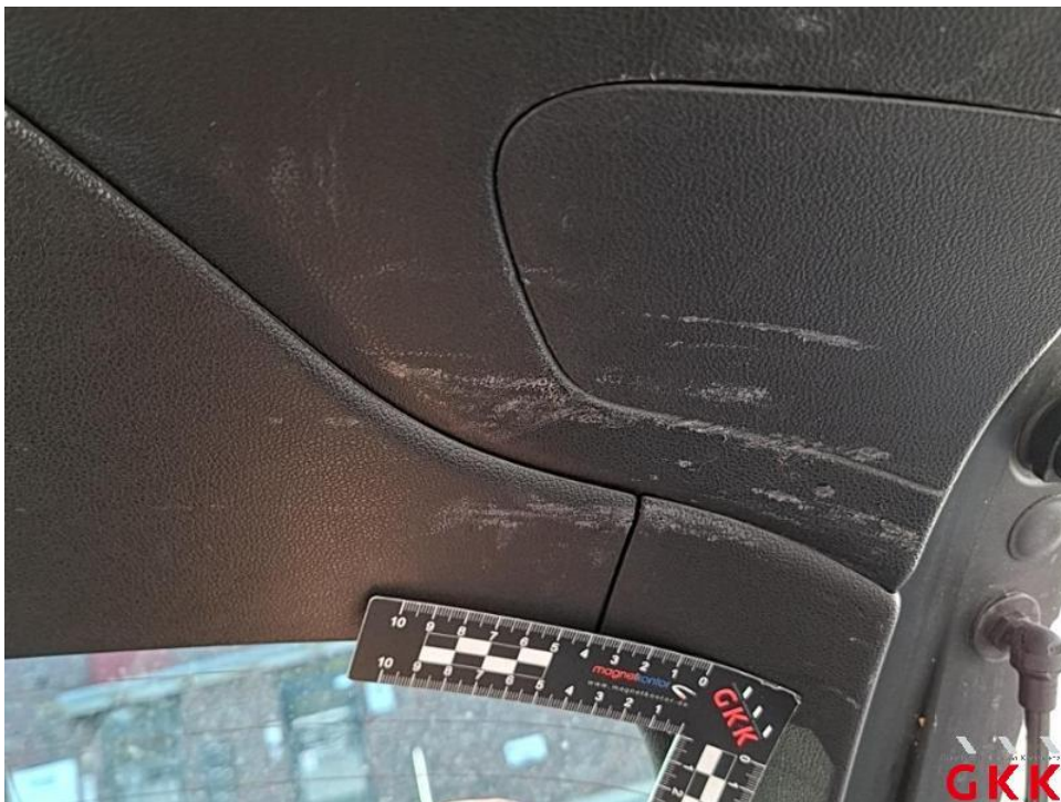
Bild 48. Heckklappe, Innenverkleidung, verkratzt, ersetzen
