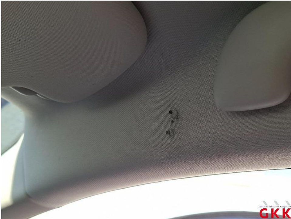
Bild 29. Himmel, Brandloch, ersetzen
