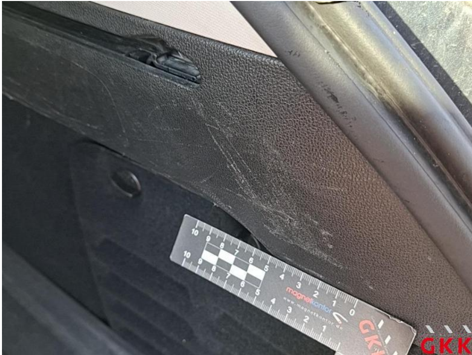
Bild 45. Seitenwand rechts, Innenverkleidung, verkratzt, Smartrepair
