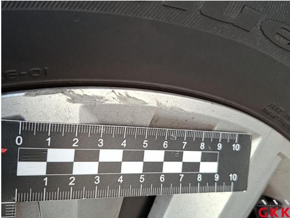
Bild 55. Radkappe(n), hinten rechts, verkratzt, ersetzen
