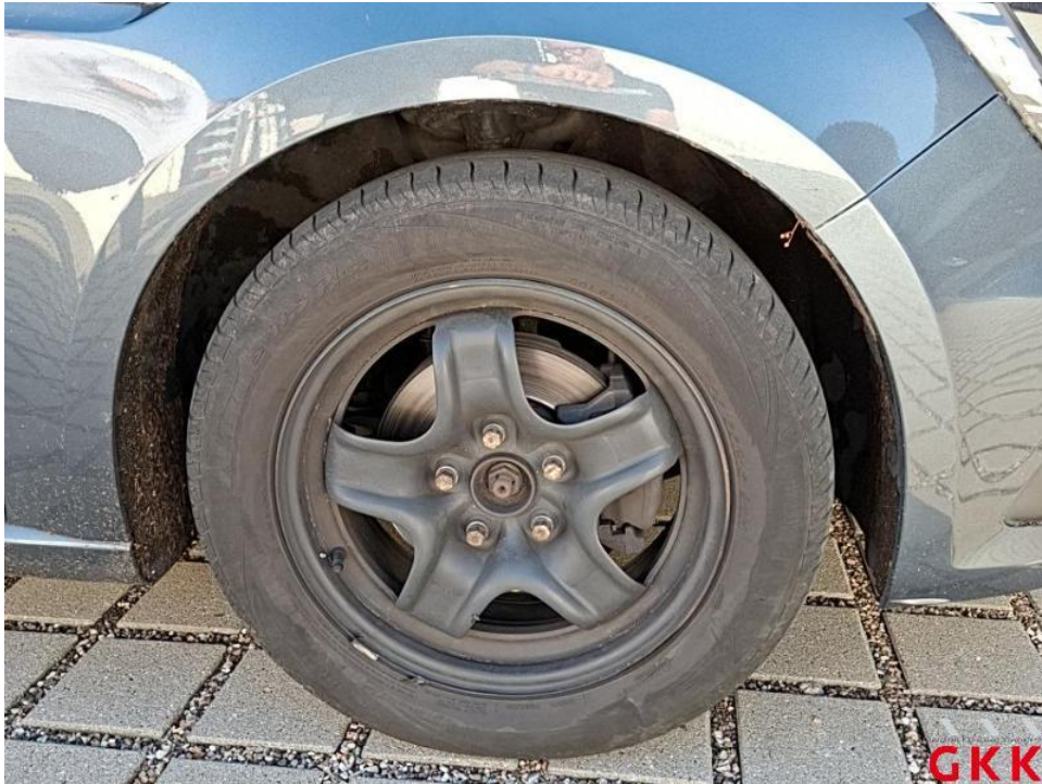
Bild 25. Radkappe(n), vorne rechts, fehlt, ersetzen
