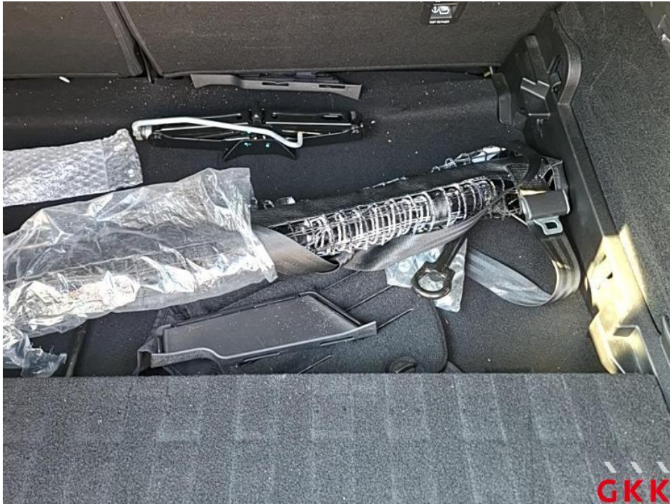
Bild 17. Laderaum, Trennnetz, beschädigt, ersetzen
