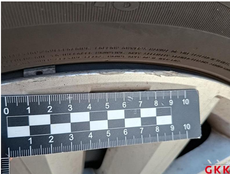
Bild 54. Radkappe(n), hinten rechts, verkratzt, ersetzen
