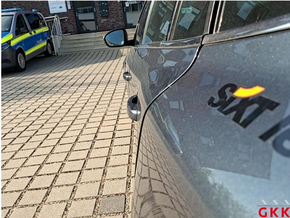
Bild 57. Tür hinten links,, Reparaturmangel, einstellen
