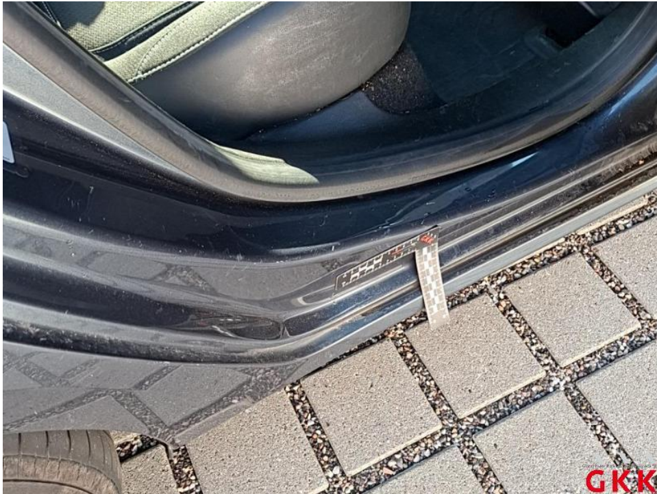
Bild 33. Tür hinten rechts, Einstieg, verkratzt, Smartrepair
