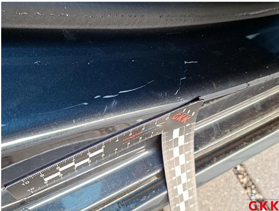
Bild 34. Tür hinten rechts, Einstieg, verkratzt, Smartrepair
