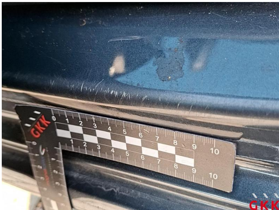
Bild 61. Tür vorne links, Einstieg, verkratzt, Smartrepair
