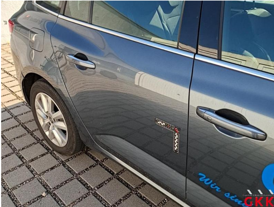
Bild 31. Tür hinten rechts, verkratzt, lackieren
