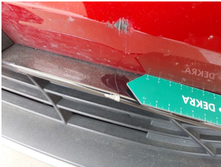
Stoßfängerleiste / Vorne / Gebrochen
