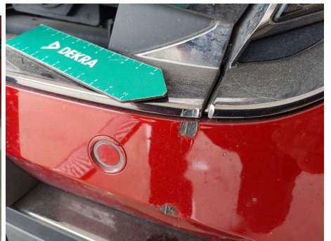
Stoßfängergrill / Vorne / Kratzer
