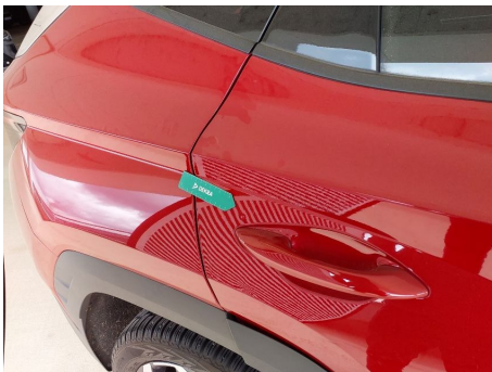
Tür / Hinten Rechts / Delle
