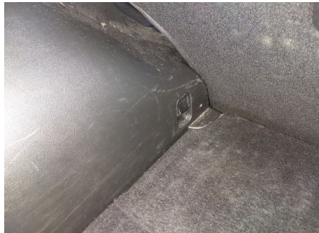
Verkl. Gepäckraum seitlich / Hinten Links / Kratzer
