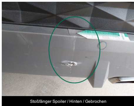
Stoßfänger / Hinten / Delle
