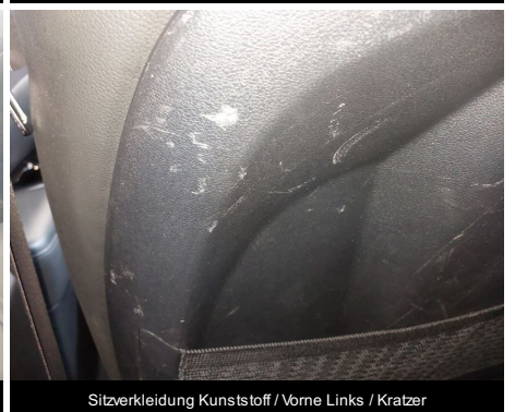
Sitzverkleidung Kunststoff / Vorne Links / Kratzer
