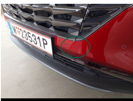
Stoßfänger / Vorne / Delle
