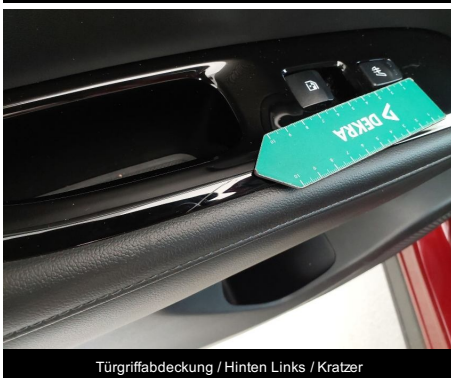
Türgriffabdeckung / Hinten Links / Kratzer
