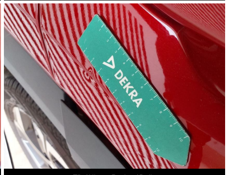
Tür / Hinten Rechts / Delle
