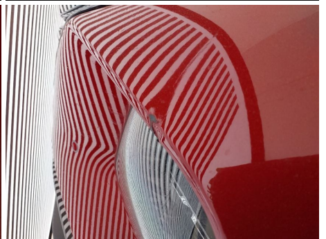
Stoßfänger / Vorne / Delle
