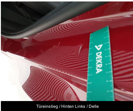
Türeinstieg / Hinten Links / Delle
