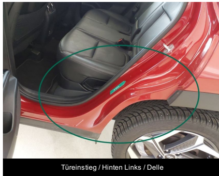
Türeinstieg / Hinten Links / Delle
