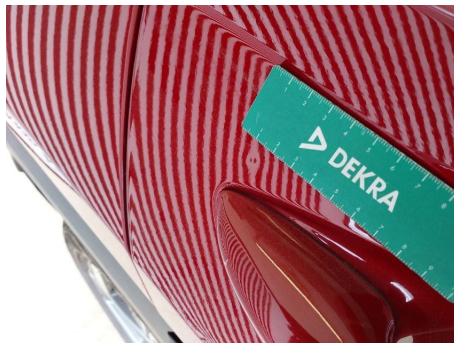
Tür / Hinten Rechts / Delle
