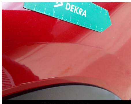
Tür / Hinten Rechts / Delle
