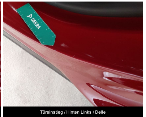
Türeinstieg / Hinten Links / Delle
