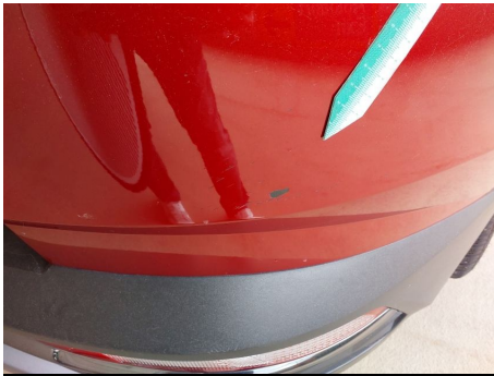
Stoßfänger / Hinten Rechts / Kratzer
