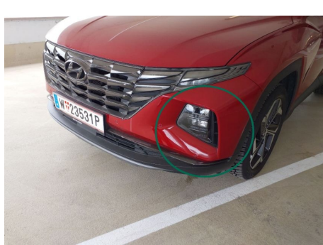
Stoßfänger / Vorne / Delle
