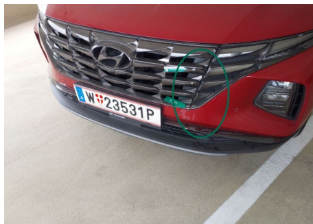
Stoßfängergrill / Vorne / Kratzer
