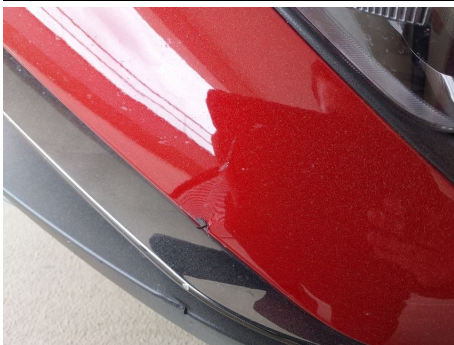
Stoßfänger / Vorne / Delle
