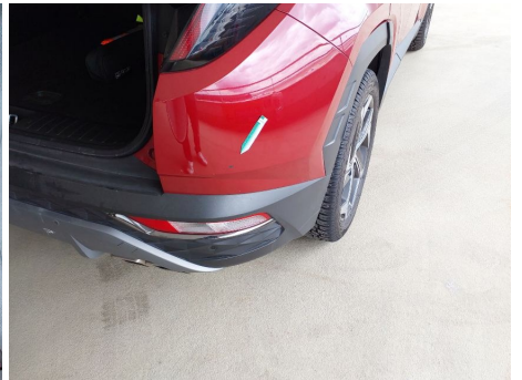
Stoßfänger / Hinten Rechts / Kratzer
