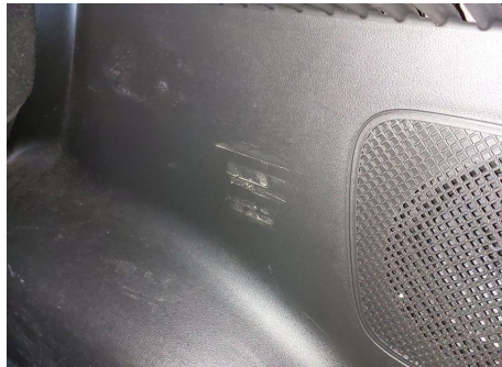
Verkl. Gepäckraum seitlich / Hinten Rechts / Kratzer
