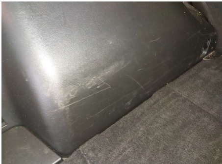
Verkl. Gepäckraum seitlich / Hinten Links / Kratzer
