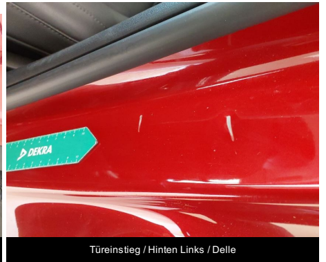
Türeinstieg / Hinten Links / Delle
