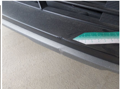
Stoßfänger Spoiler / Vorne / Delle
