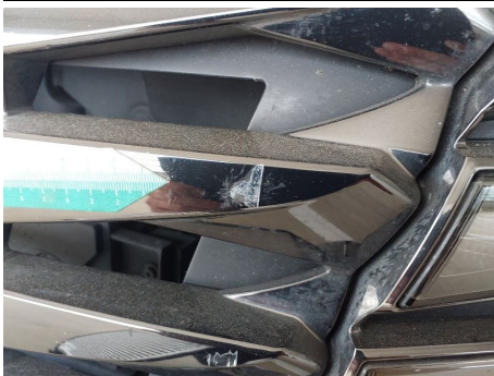
Stoßfängergrill / Vorne / Kratzer
