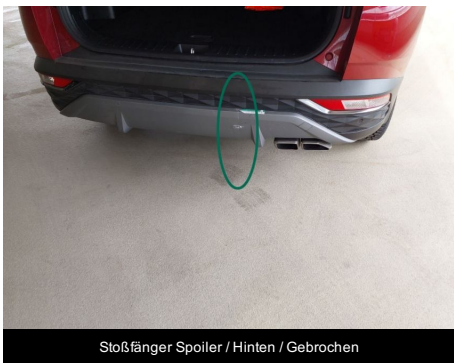
Stoßfänger / Hinten / Delle
