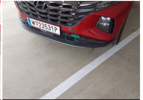
Stoßfängerleiste / Vorne / Gebrochen
