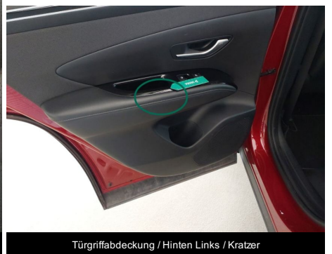
Türgriffabdeckung / Hinten Links / Kratzer
