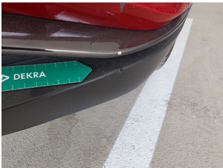
Stoßfänger Spoiler / Vorne / Delle
