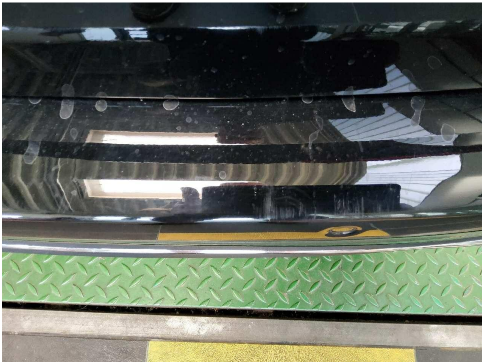
Bild 14 : Stoßfänger hinten Lackierung, verschrammt, Gebrauchsspur
