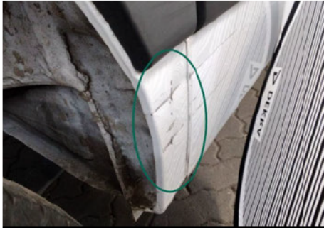
Schweller / Hinten Rechts / Delle
