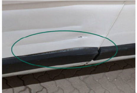
Seitenwand / Unten Vorne Links / Delle
