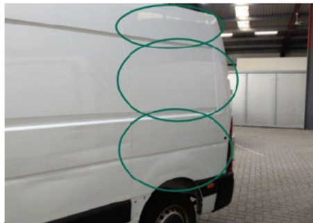
Seitenwand / Hinten Links / Delle
