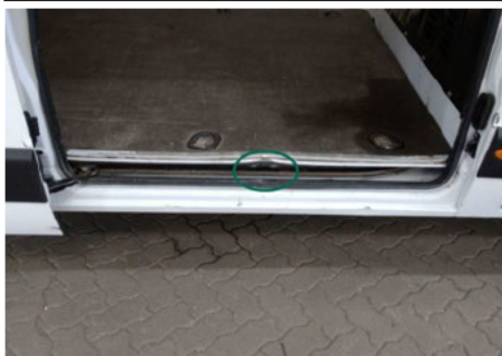
Führung Schiebetür / Rechts / Delle
