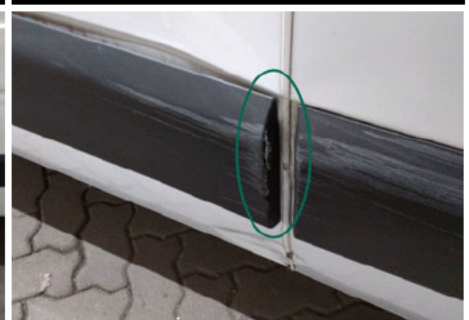
Zierleiste Seitenwand / Vorne Links / Gebrochen
