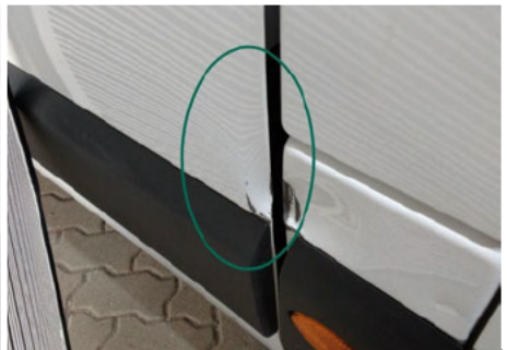
Tür / Rechts / Delle
