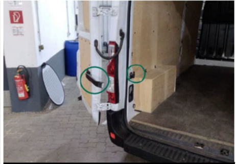
Türfangband / Hinten Links / Defekt
