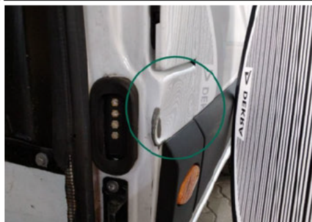
B-Säule außen / Unten Rechts / Delle
