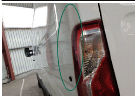
Säule / Hinten Links / Delle
