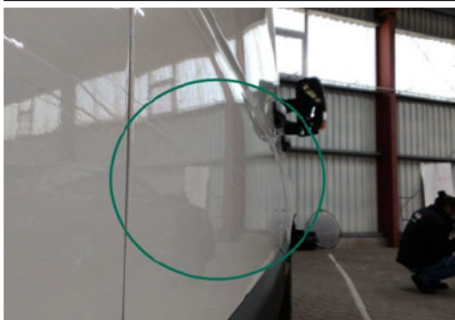
Tür / Rechts / Delle
