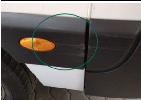
Zierleiste Seitenwand / Hinten Links / Kratzer
