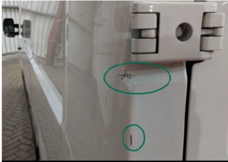
Säule / Hinten Links / Delle
