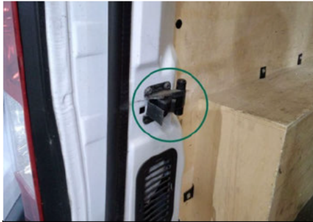
Türfangband / Hinten Links / Defekt
