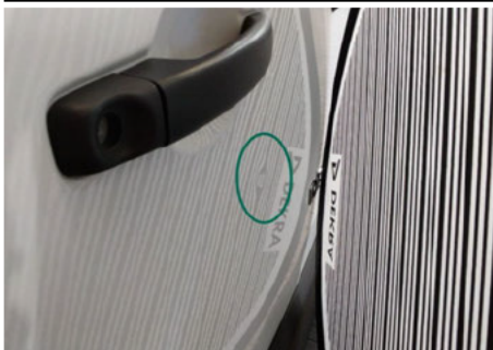
Heckklappe / Kofferraumtür / Rechts / Delle
