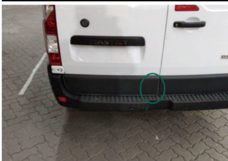
Zierleiste Heckklappe / Links / Kratzer
