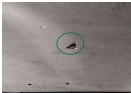
Innenverkleidung Laderaum / Vorne Links / Gebrochen
