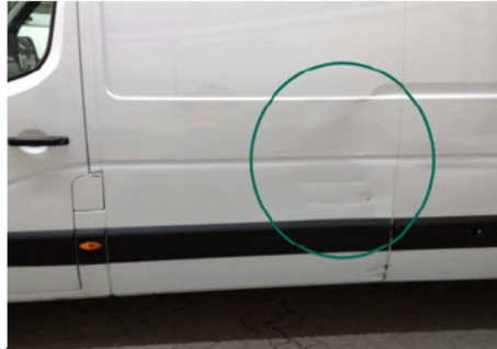
Seitenwand / Unten Vorne Links / Delle
