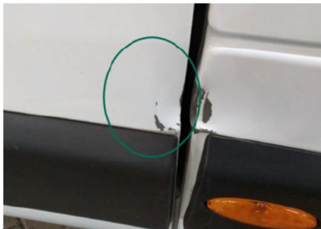
Tür / Rechts / Delle
