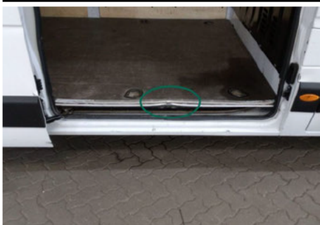
Kofferraumboden / Rechts / Delle
