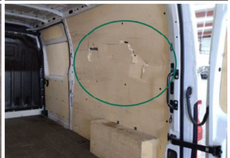
Innenverkleidung Laderaum / Rechts / Gebrochen
