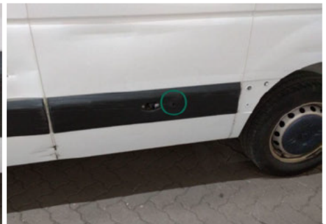
Sensor Einparkhilfe gehäuse / Links / Kratzer
