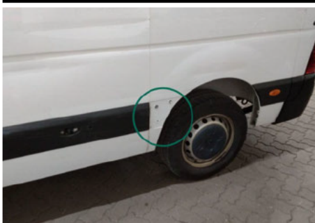
Zierleiste Seitenwand / Hinten Links / Fehlt
