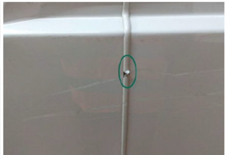
Seitenwand / Unten Vorne Links / Delle
