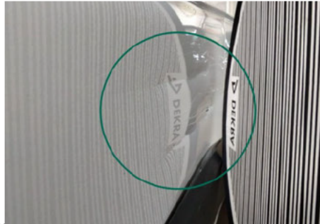
Seitenwand / Unten Vorne Links / Delle
