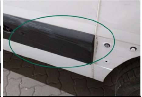
Zierleiste Seitenwand / Links / Kratzer
