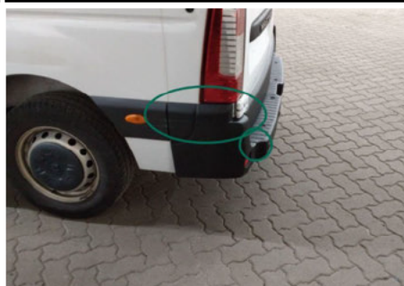
Stoßfänger / Hinten Links / Kratzer
