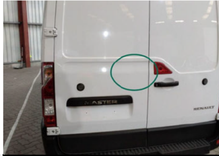
Heckklappe / Kofferraumtür / Links / Delle
