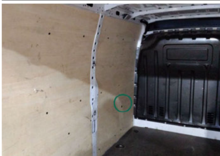
Innenverkleidung Laderaum / Vorne Links / Gebrochen
