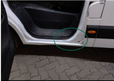
Türeinstieg / Vorne Links / Abgewetzt
