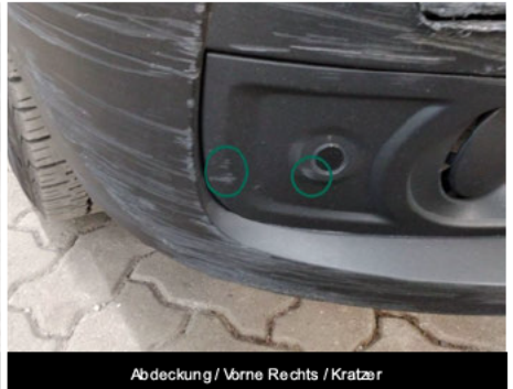
Abdeckung / Vorne Rechts / Kratzer
