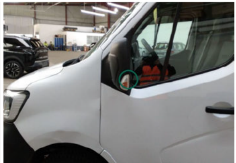
Blinker / Links / Gebrochen
