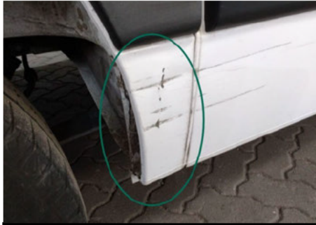
Schweller / Hinten Rechts / Delle
