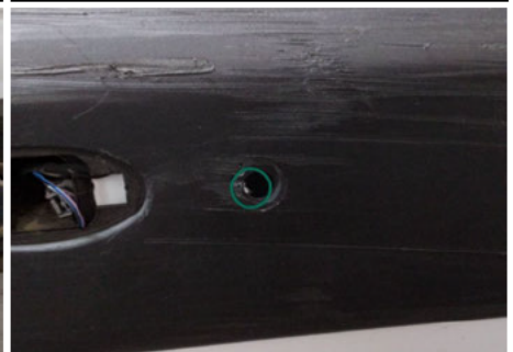
Sensor Einparkhilfe / Links / Kratzer
