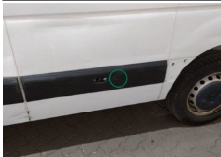
Sensor Einparkhilfe / Links / Kratzer
