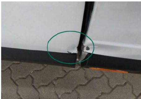
Tür / Rechts / Delle
