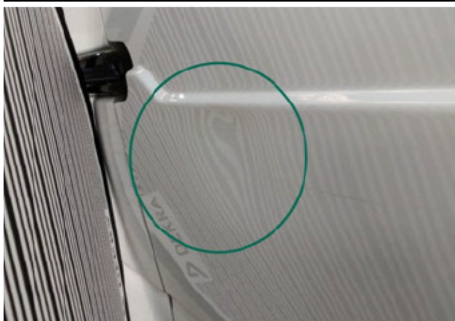
Tür / Rechts / Delle
