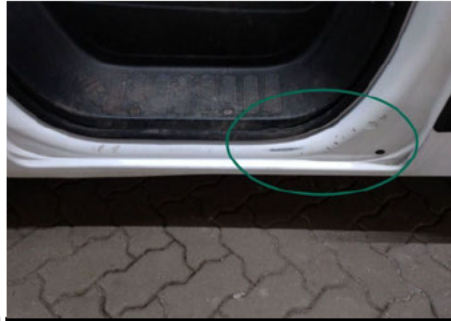
Türeinstieg / Vorne Links / Abgewetzt
