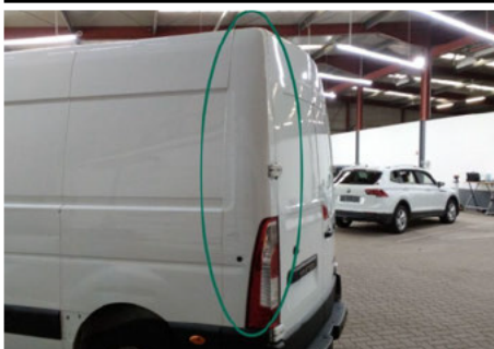
Säule / Hinten Links / Delle
