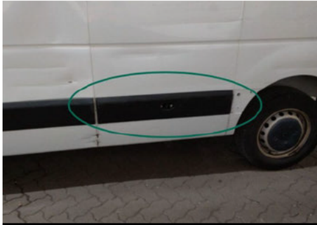
Zierleiste Seitenwand / Links / Kratzer
