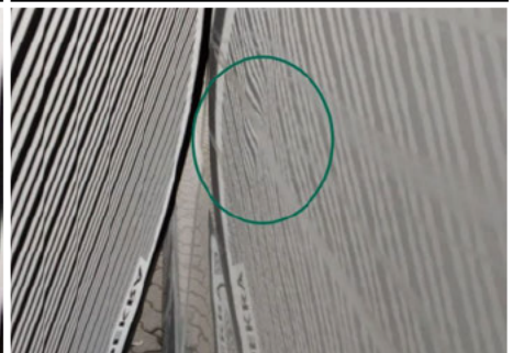
Seitenwand / Hinten Links / Delle
