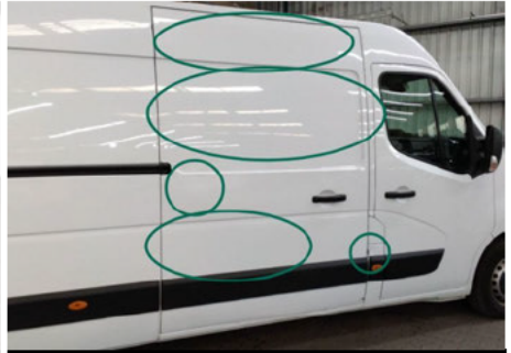
Tür / Rechts / Delle
