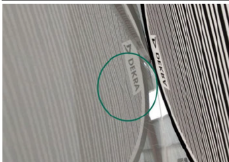
Seitenwand / Hinten Rechts / Delle
