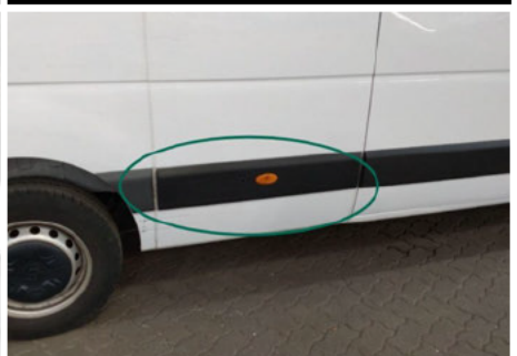
Zierleiste Seitenwand / Rechts / Kratzer
