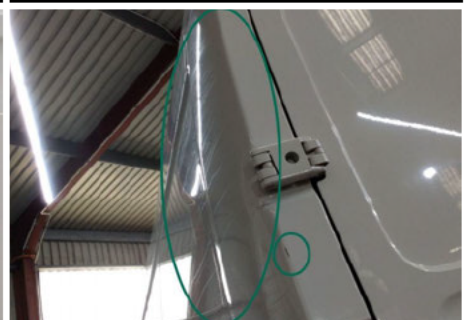
Säule / Hinten Links / Delle
