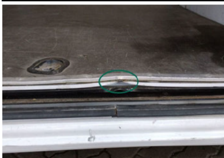
Kofferraumboden / Rechts / Delle
