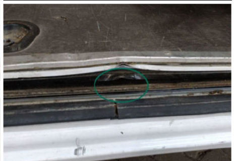
Führung Schiebetür / Rechts / Delle
