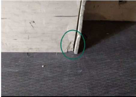
Abdeckung / Hinten Links / Gebrochen
