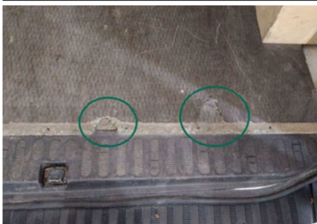
Holzboden / Hinten / Gebrochen
