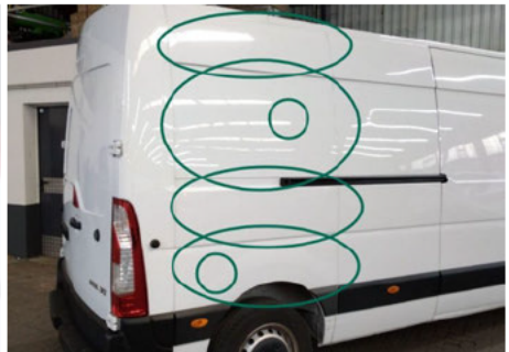
Seitenwand / Hinten Rechts / Delle
