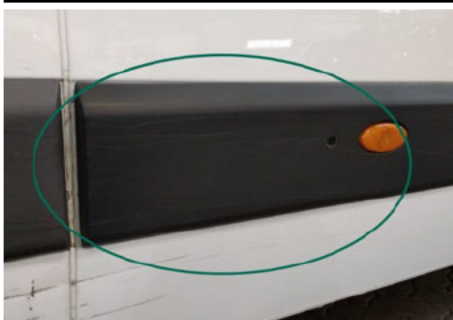
Zierleiste Seitenwand / Rechts / Kratzer
