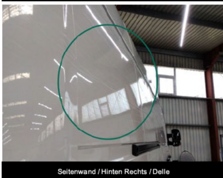
Seitenwand / Hinten Rechts / Delle
