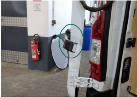
Türfangband / Hinten Links / Defekt
