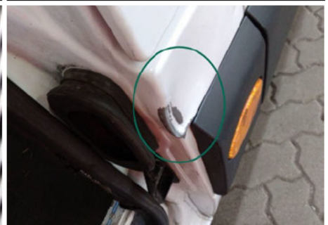
B-Säule außen / Unten Rechts / Delle
