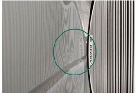
Seitenwand / Unten Vorne Links / Delle
