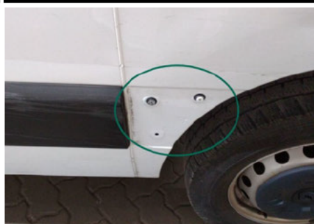
Zierleiste Seitenwand / Hinten Links / Fehlt
