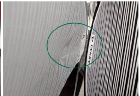
Seitenwand / Hinten Links / Delle
