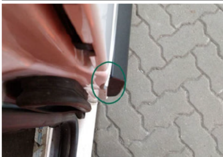
B-Säule außen / Unten Rechts / Delle
