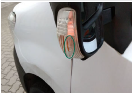
Blinker / Links / Gebrochen
