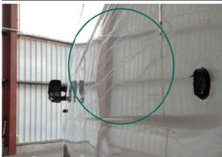
Seitenwand / Hinten Links / Delle
