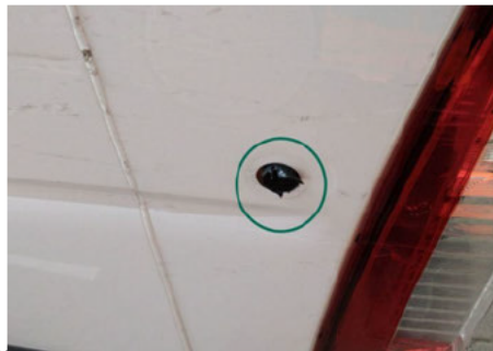
Türanschlag/-puffer / Hinten Links / Gebrochen
