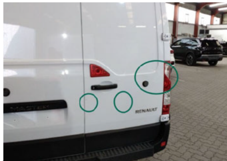
Heckklappe / Kofferraumtür / Rechts / Delle
