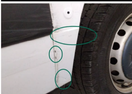
Schweller / Hinten Links / Kratzer
