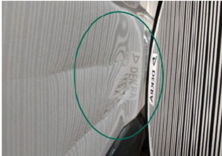
Seitenwand / Unten Vorne Links / Delle
