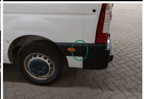
Zierleiste Seitenwand / Hinten Links / Kratzer
