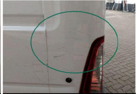
Säule / Hinten Links / Delle
