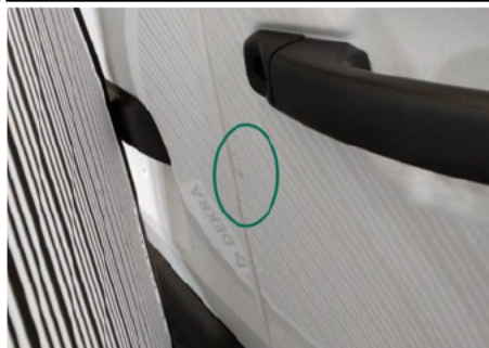
Heckklappe / Kofferraumtür / Rechts / Delle
