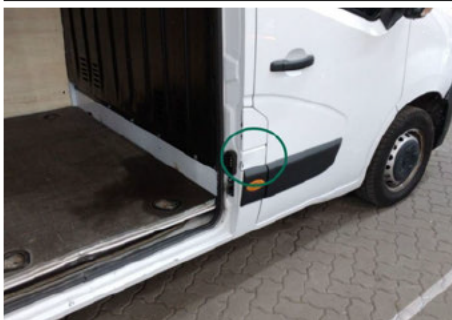
B-Säule außen / Unten Rechts / Delle
