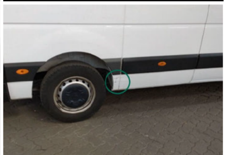
Schweller / Hinten Rechts / Delle
