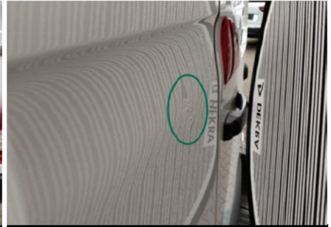
Heckklappe / Kofferraumtür / Links / Delle
