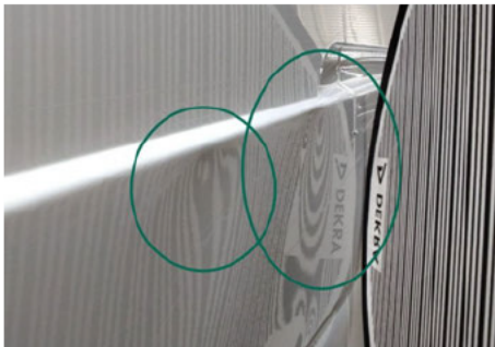
Seitenwand / Unten Vorne Links / Delle
