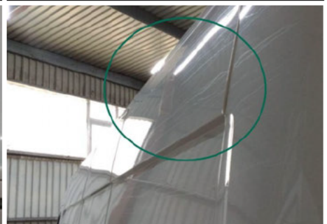
Seitenwand / Hinten Links / Delle
