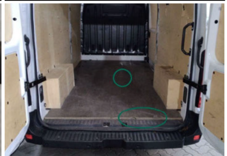
Holzboden / Hinten / Gebrochen
