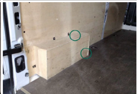
Abdeckung / Hinten Links / Gebrochen
