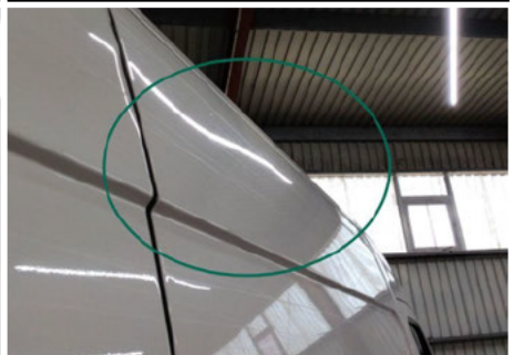
Tür / Rechts / Delle
