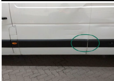
Zierleiste Seitenwand / Vorne Links / Gebrochen
