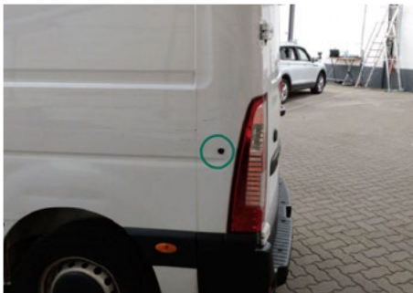
Türanschlag/-puffer / Hinten Links / Gebrochen
