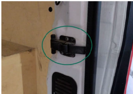
Türfangband / Hinten Links / Defekt
