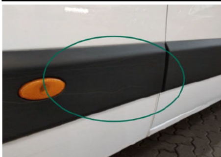
Zierleiste Seitenwand / Rechts / Kratzer
