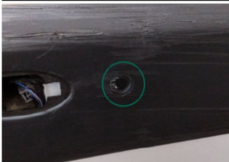
Sensor Einparkhilfe gehäuse / Links / Kratzer
