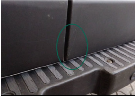
Zielfeld Heckklappe / Rechts / Kratzer
