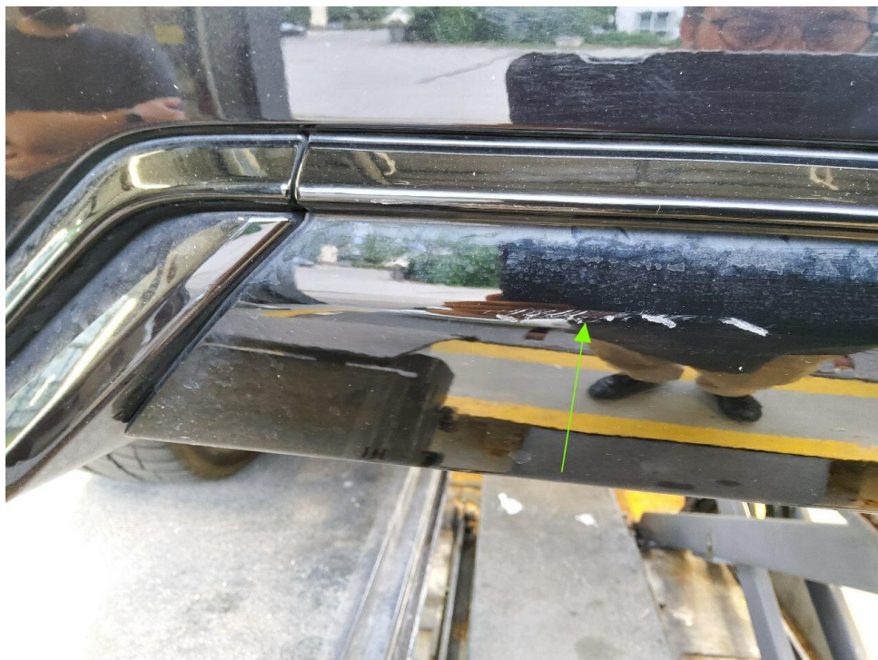
Bild 14 : Stoßfänger hinten unten zerkratzt
