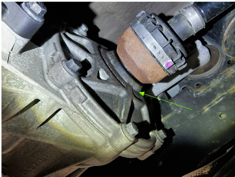
Bild 15 : Differential hinten Ölfeucht
