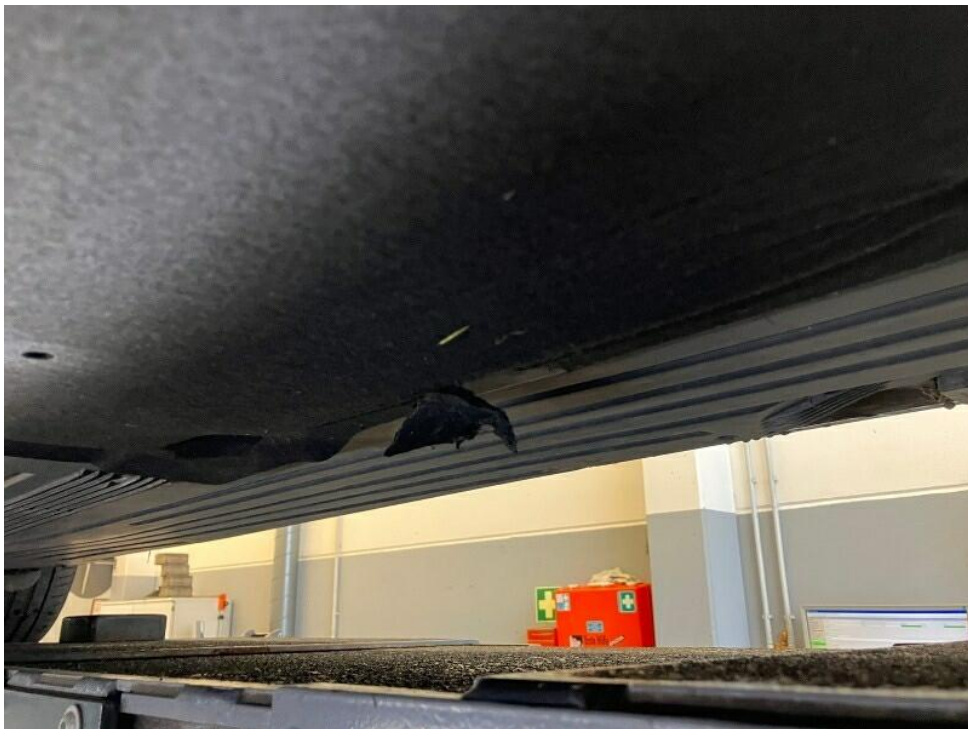
Bild 26 : Unterbodenverkleidung Mitte eingerissen
