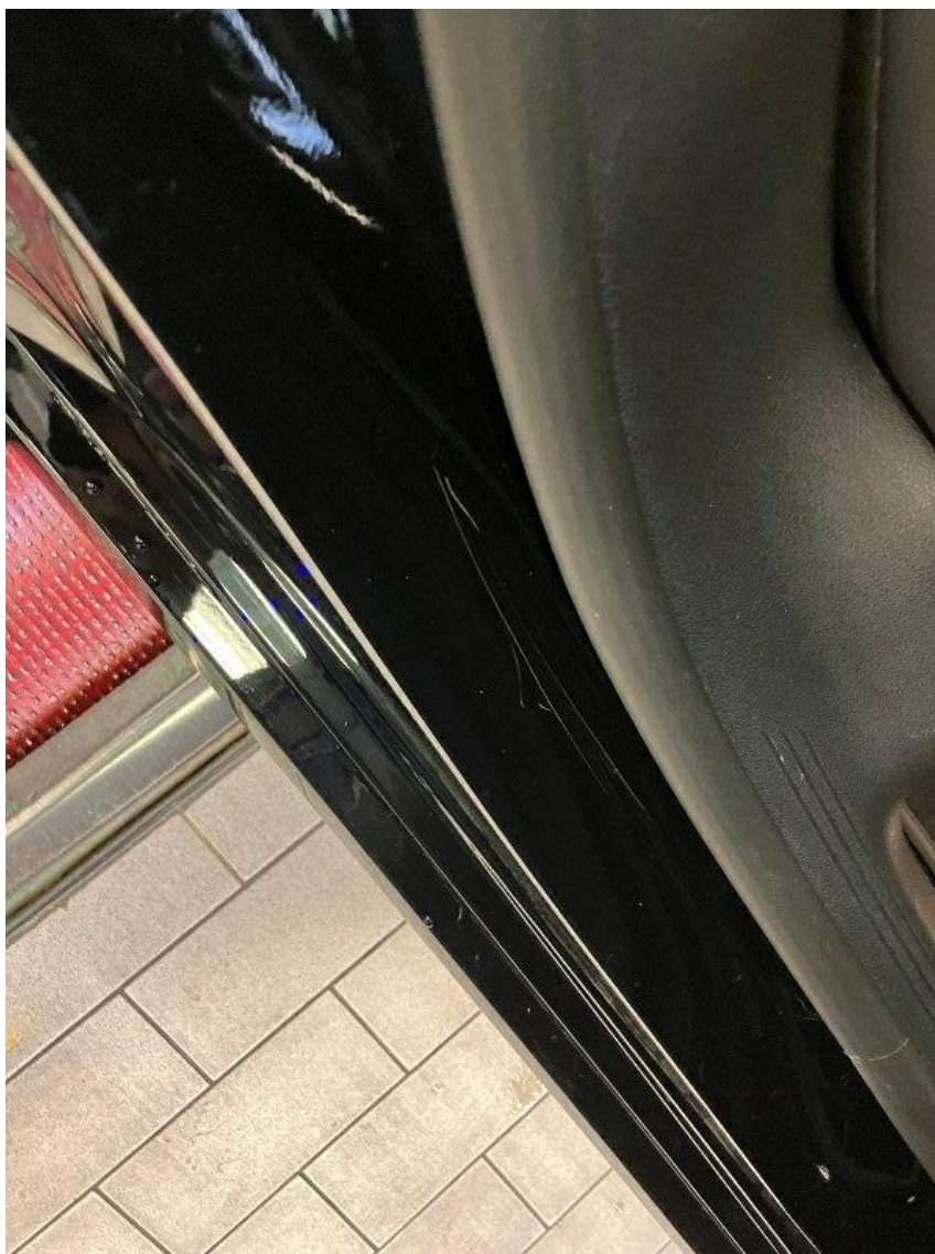
Bild 15 : Einstieg hinten rechts verkratzt
