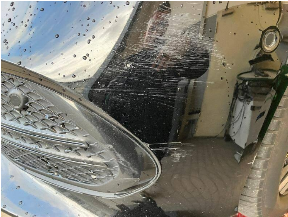
Bild 17 : Stoßfänger vorn in mehreren Bereichen verkratzt Blende Stoßfänger vorn links abgeschürft
