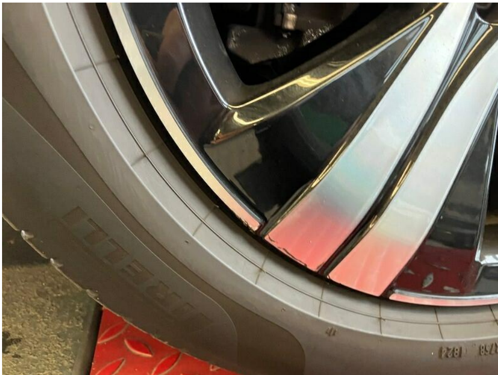
Bild 24 : Felge vorn rechts verkratzt
