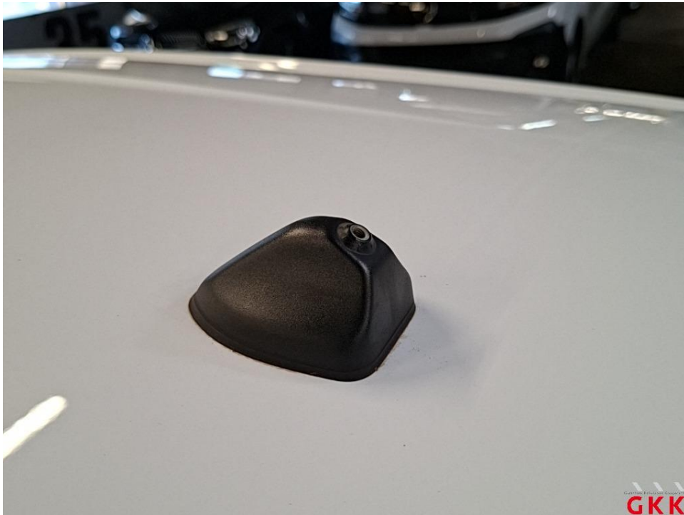
Bild 17 Antenne, Stab, fehlt, ersetzen
