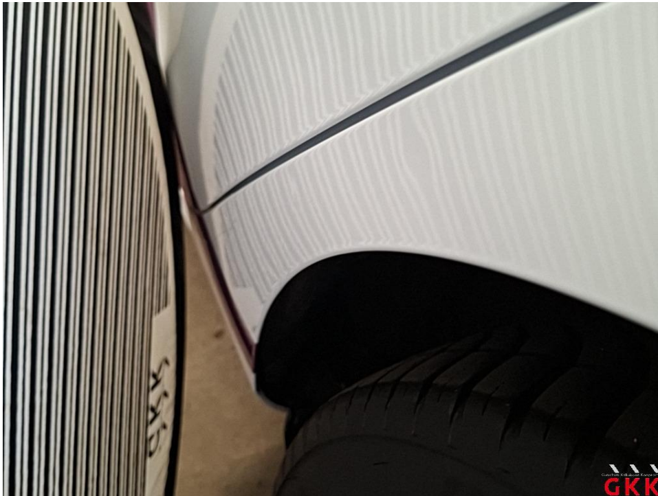
Bild 19 Seitenwand links, unterhalb, beschädigt, Smartrepair
