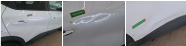
Porte ARD, Bosse(s) et griffe(s), LI - Réparer et peindre (complet)
