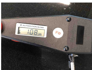
Lackstärke Seitenwand hinten rechts
