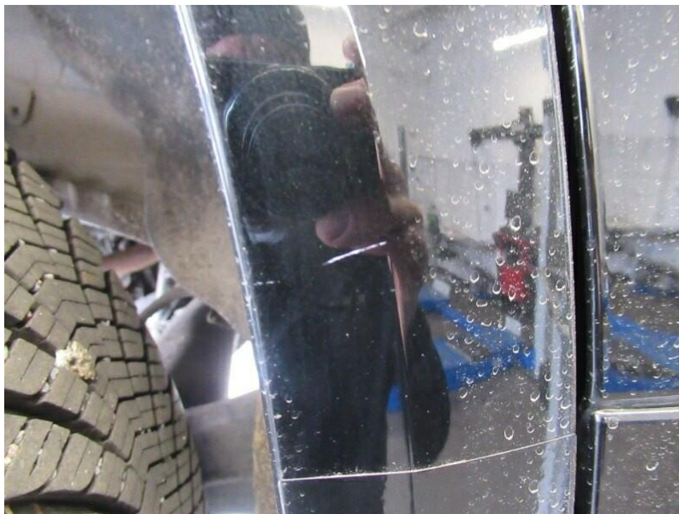
Bild 13 : Radlaufblende hinten rechts verschrammt
