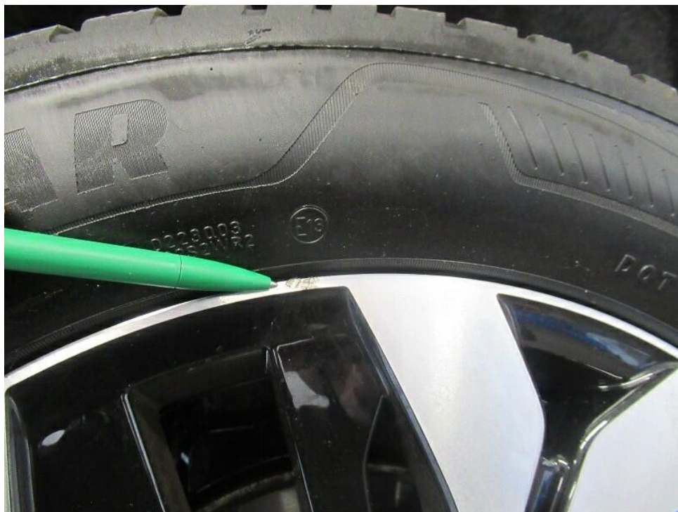
Bild 12 : Felge vorne rechts gekerbt
