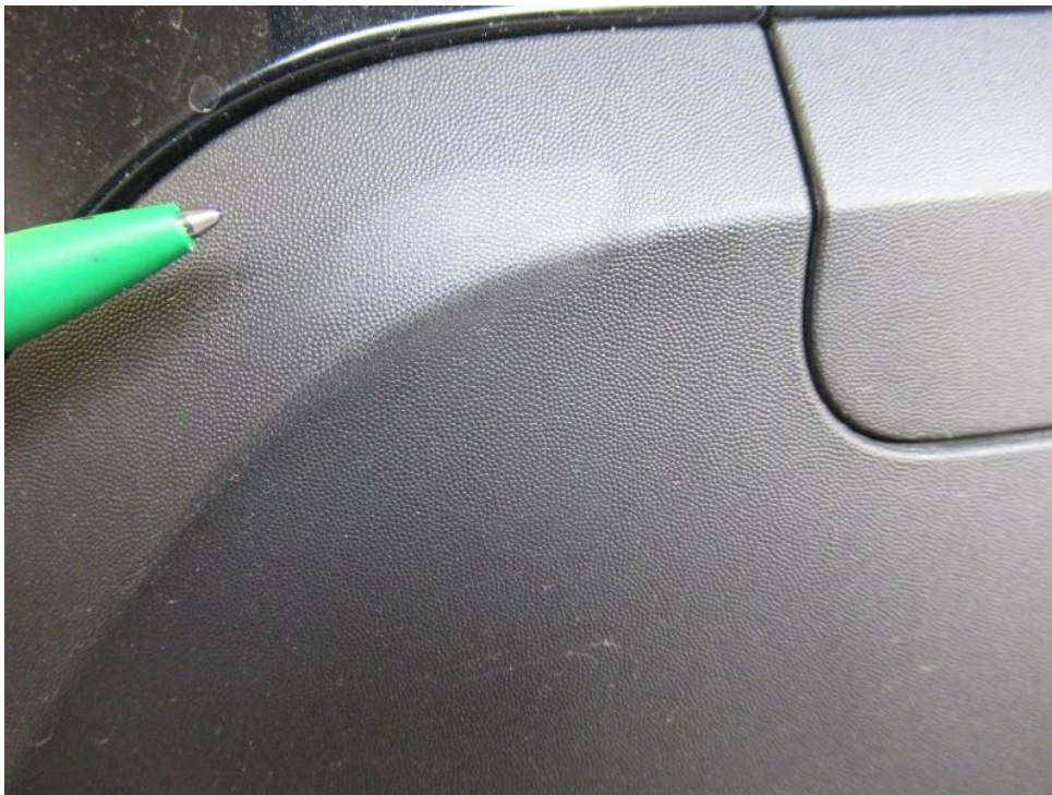
Bild 15 : Stoßfängerunterteil / Spoiler mitte hinten gekerbt
