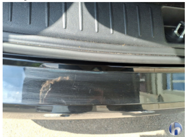
2. Stoßfänger Hinten Kratzer - Lackieren
