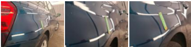
Porte ARD, Mauvaise réparation, Peindre
