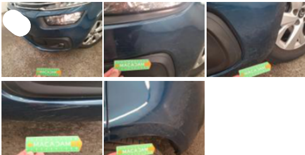
Aile ARD, Mauvaise réparation, Peindre
