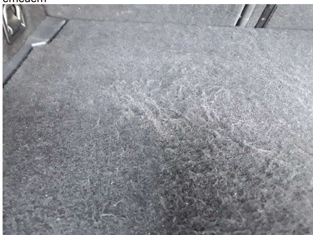
Beschädigung #2: Heckbereich: Kofferboden - verschlissen - erneuern
