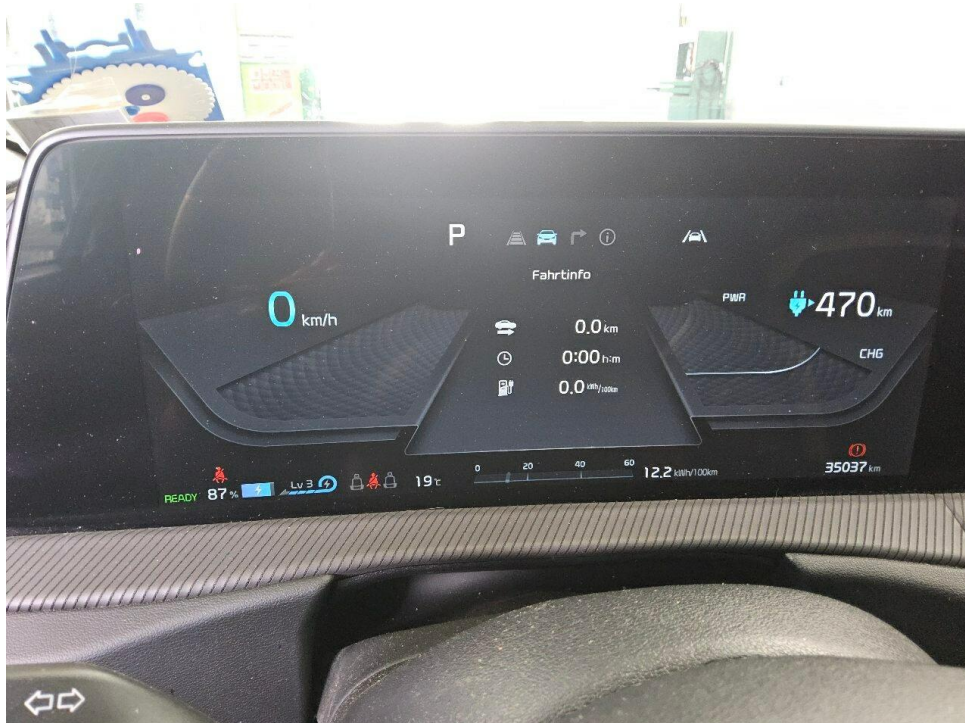
Bild 4 : Kombiinstrument (betriebsbereit) mit Km-Stand
