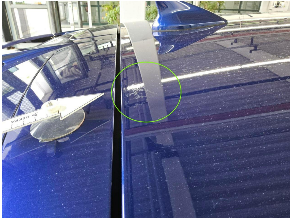
Bild 9 : Dach Lackierung, Umweltschaden, smart repair
