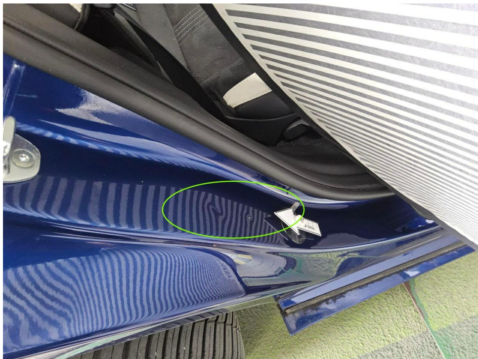
Bild 8 : Tür hinten rechts Einstieg, eingedellt, smart repair
