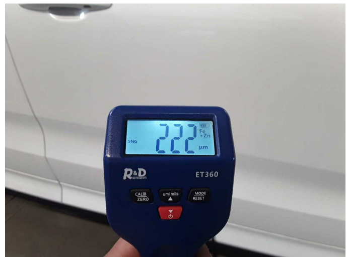
Door - front right side: 222 µm
