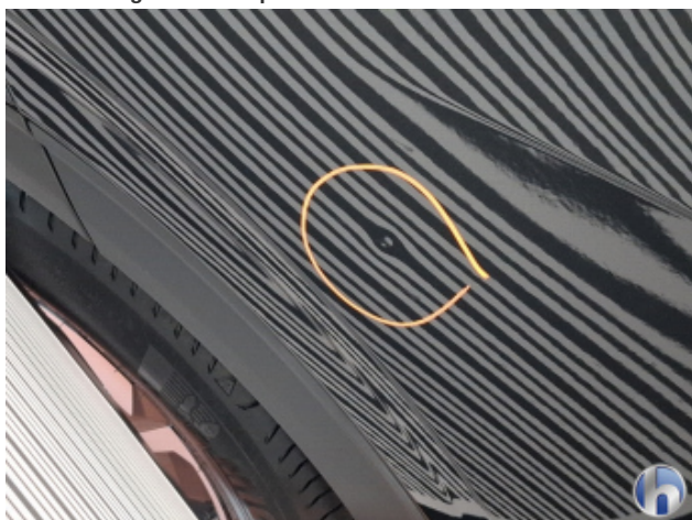
3. Tür Hinten - Rechts Gebrauchsspuren - Ohne Reparatur
