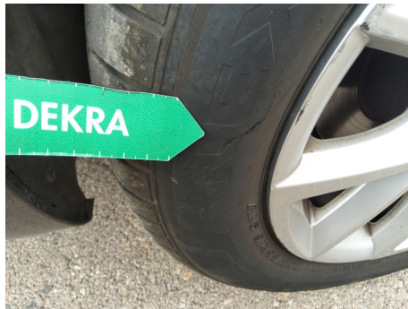
Neumático / Trasero Derecho / Desgarro
