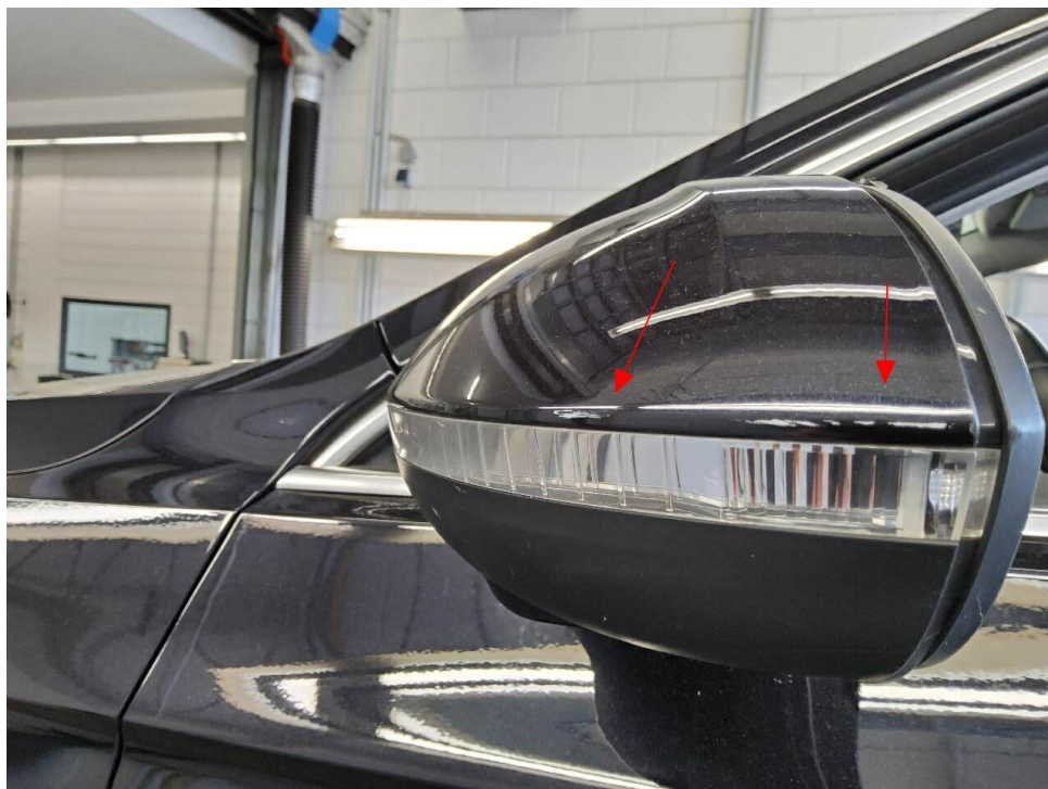
Bild 20 : Spiegelkappe links Kratzer
