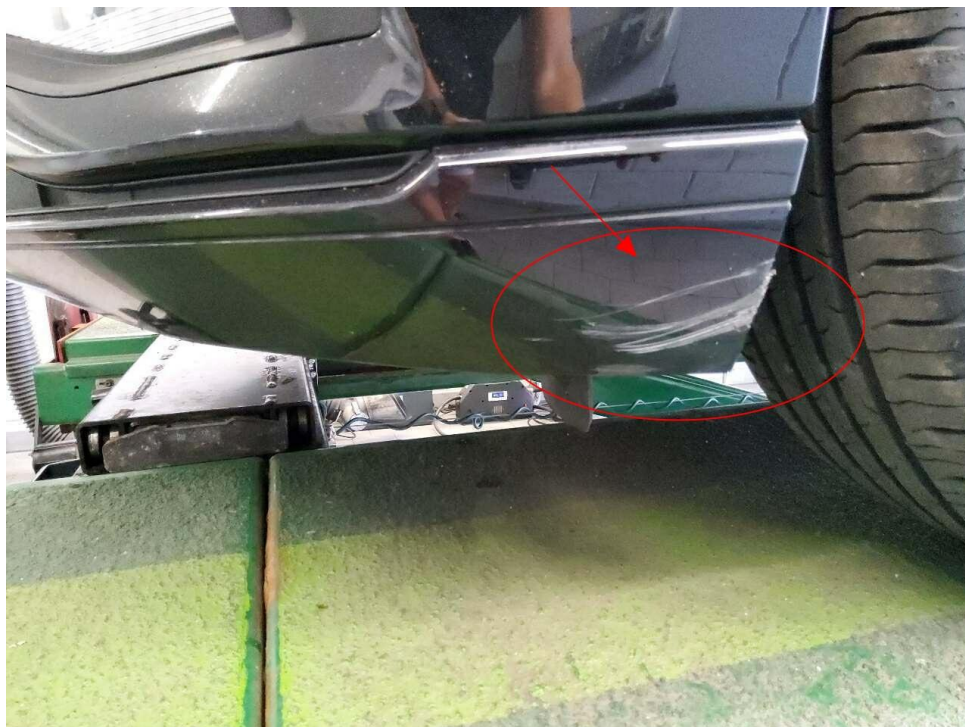
Bild 16 : Stoßfänger vorne Kratzer
