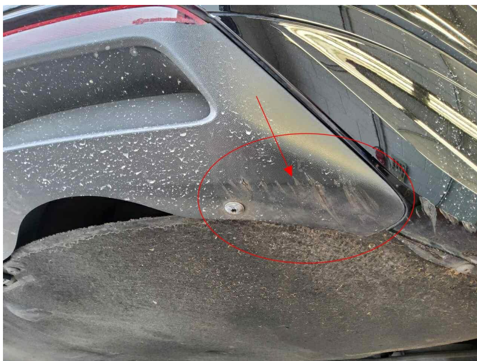
Bild 22 : Spoiler hinten verschrammt
