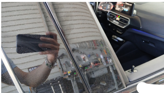
8. B-colonna centrale - destra Graffi superficiali
