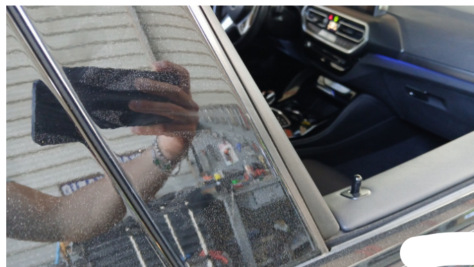
8. B-colonna centrale - destra Graffi superficiali
