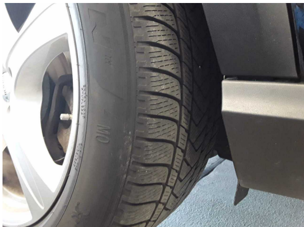
Beschädigung #1: Rad/Reifen: Reifen hinten - verschlissen - kein Abzug
