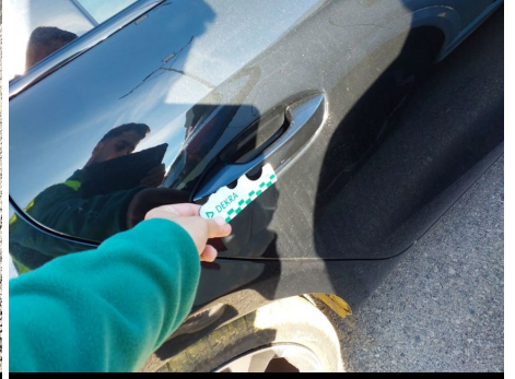
Manetas de puerta / Trasero Derecho / Rayado
