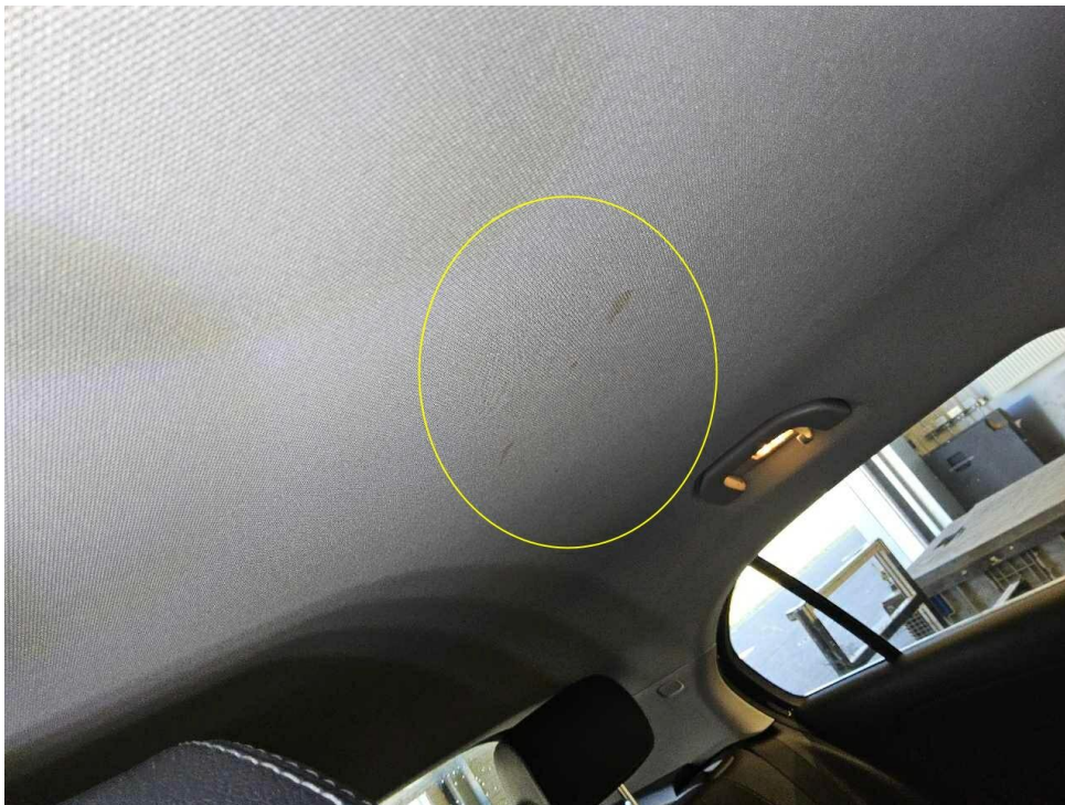
Bild 22 : Dachhimmel, fleckig, reinigen
