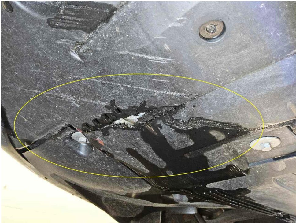
Bild 13 : Vorderer Unterfahrschutz gebrochen
