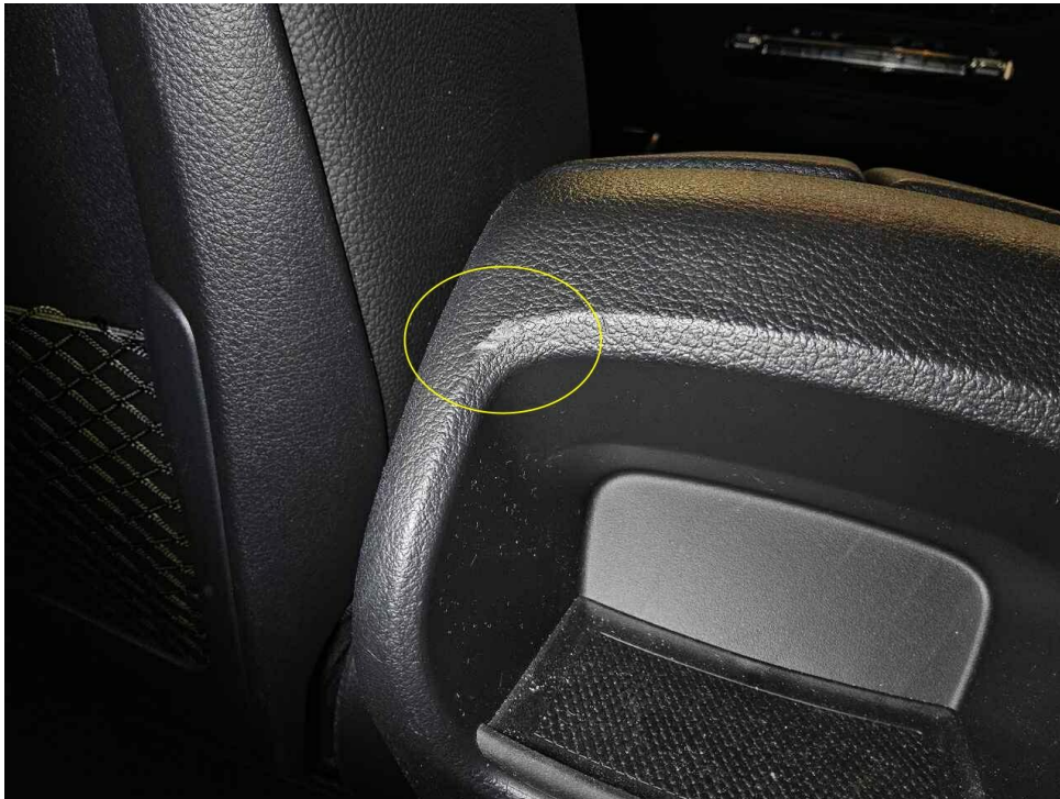
Bild 25 : Mittelkonsole Fondbereich leichte Abschürfung
