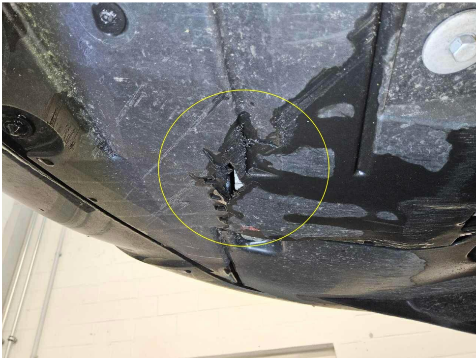
Bild 14 : Vorderer Unterfahrschutz gebrochen
