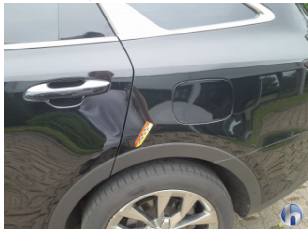
2. Seitenwand - Hinten - Links Kratzer - Smart Repair
