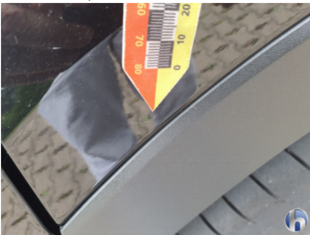
2. Seitenwand - Hinten - Links Kratzer - Smart Repair
