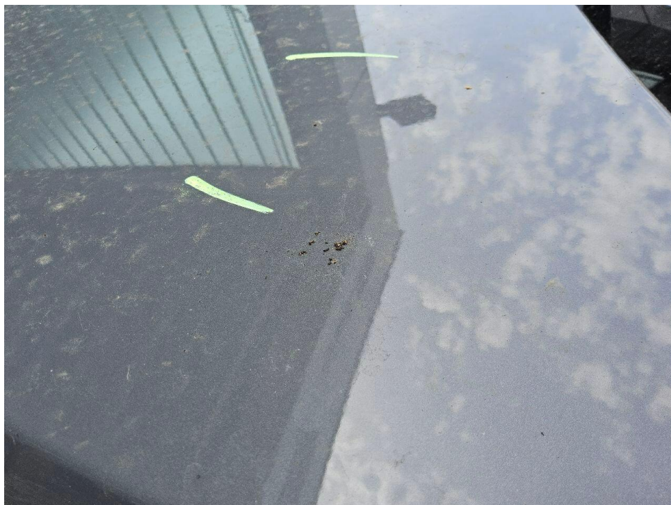
Bild 12 : Motorhaube Lackierung, Umweltschaden, polieren
