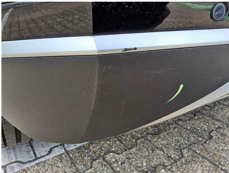
Bild 11 : Stoßfänger hinten eingedrückt und verschrammt
