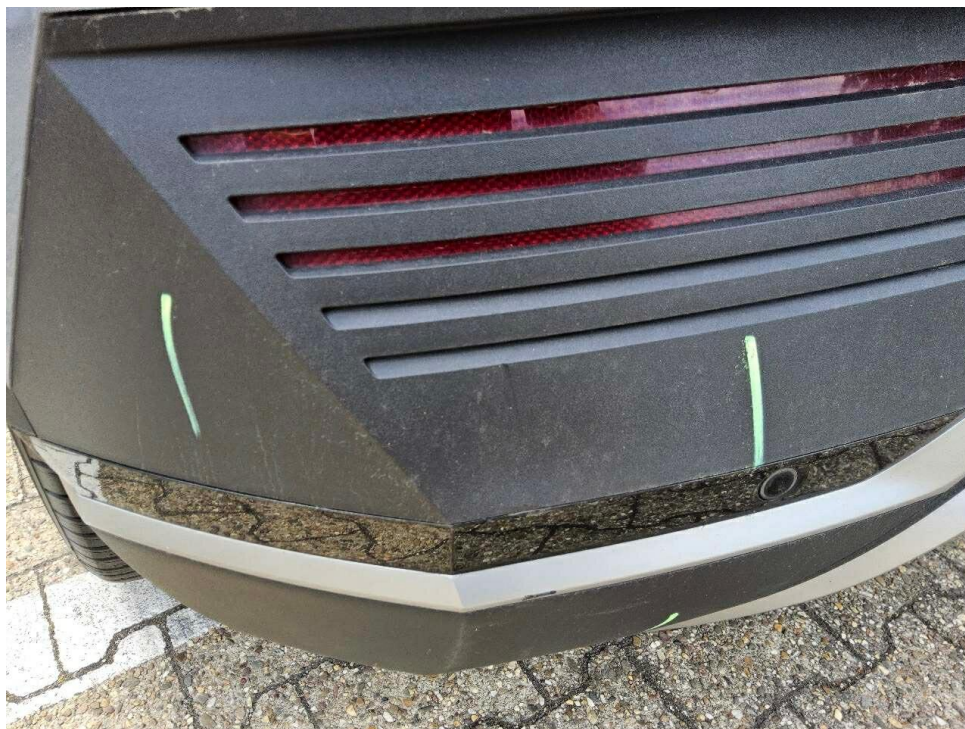
Bild 9 : Stoßfänger hinten eingedrückt und verschrammt
