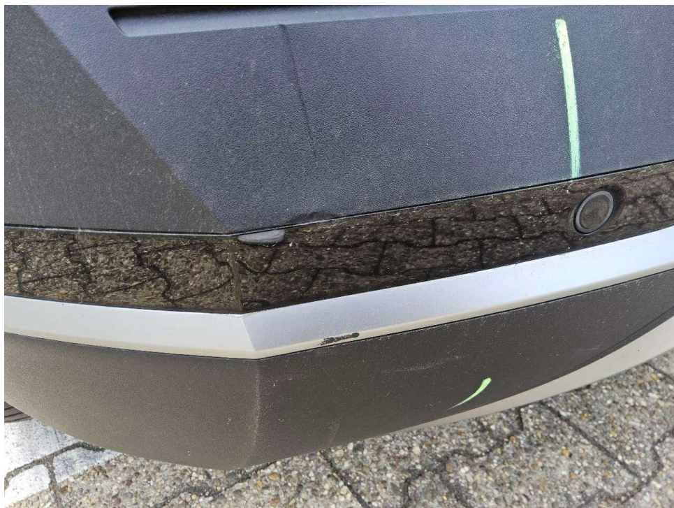
Bild 10 : Stoßfänger hinten eingedrückt und verschrammt
