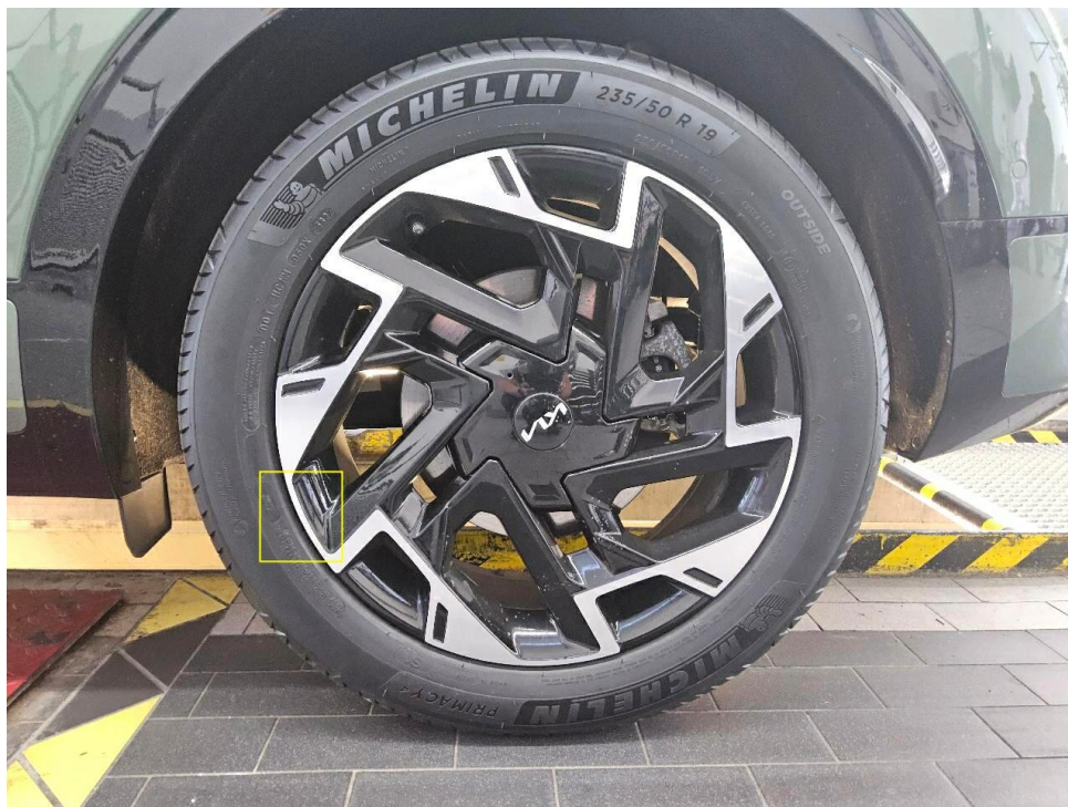
Bild 7 : Felge hinten links, zerkratzt
