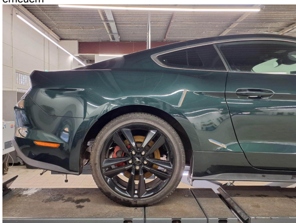
Beschädigung 7: Seitenwand rechts: Seitenwand - verformt - instandsetzen und lackieren
