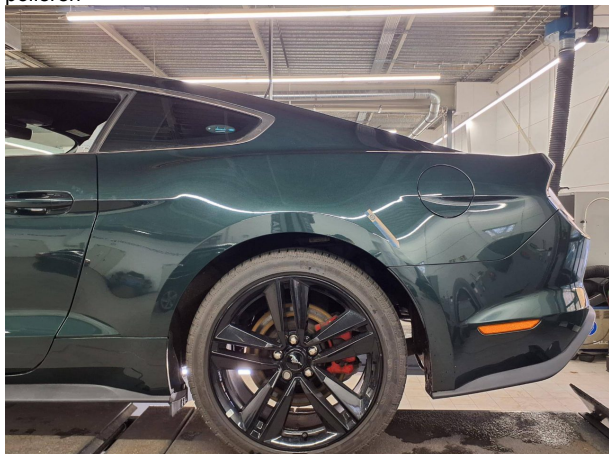
Beschädigung 3: Seitenwand links: Seitenwand - Delle(n) - sanft instandsetzen
