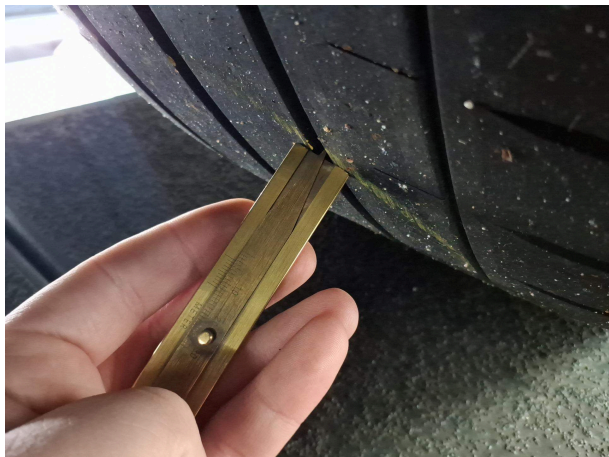
Beschädigung 6: Rad/Reifen: Reifen hinten - verschlissen - erneuern
