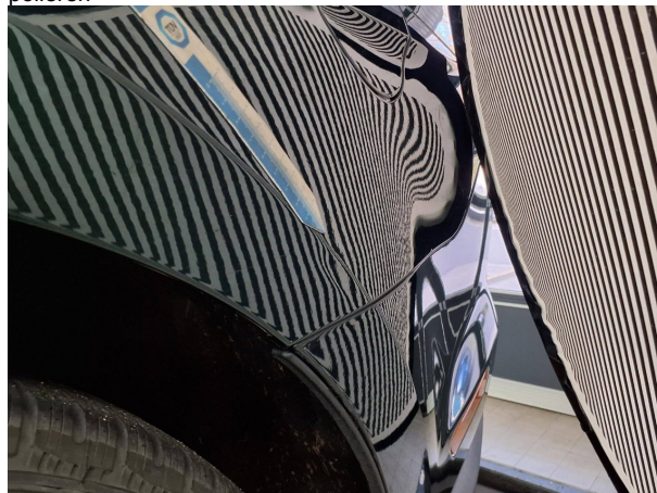
Beschädigung 3: Seitenwand links: Seitenwand - Delle(n) - sanft instandsetzen
