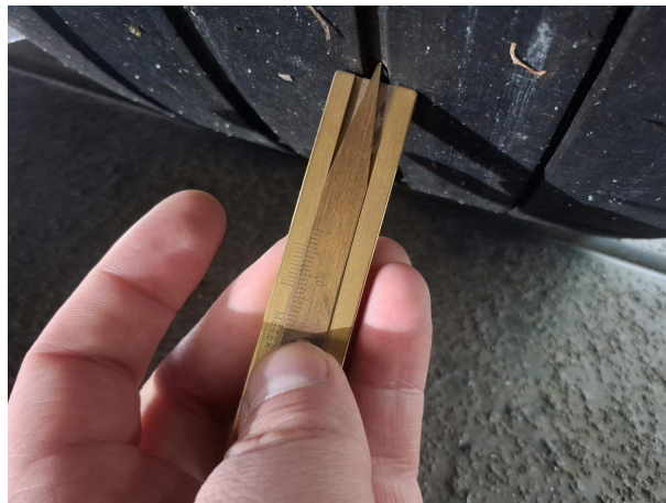
Beschädigung 6: Rad/Reifen: Reifen hinten - verschlissen - erneuern
