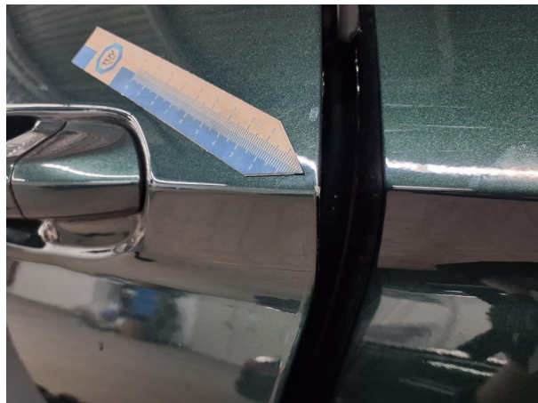
Beschädigung 2: Tür vorn links: Türkante - Abrieb - auslege... polieren
