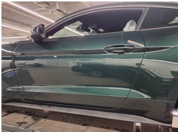
Beschädigung 2: Tür vorn links: Türkante - Abrieb - auslegen / polieren
