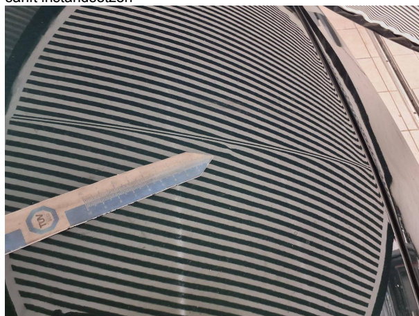
Beschädigung 4: Motorhaube: Motorhaube - Delle(n) - sanft instandsetzen
