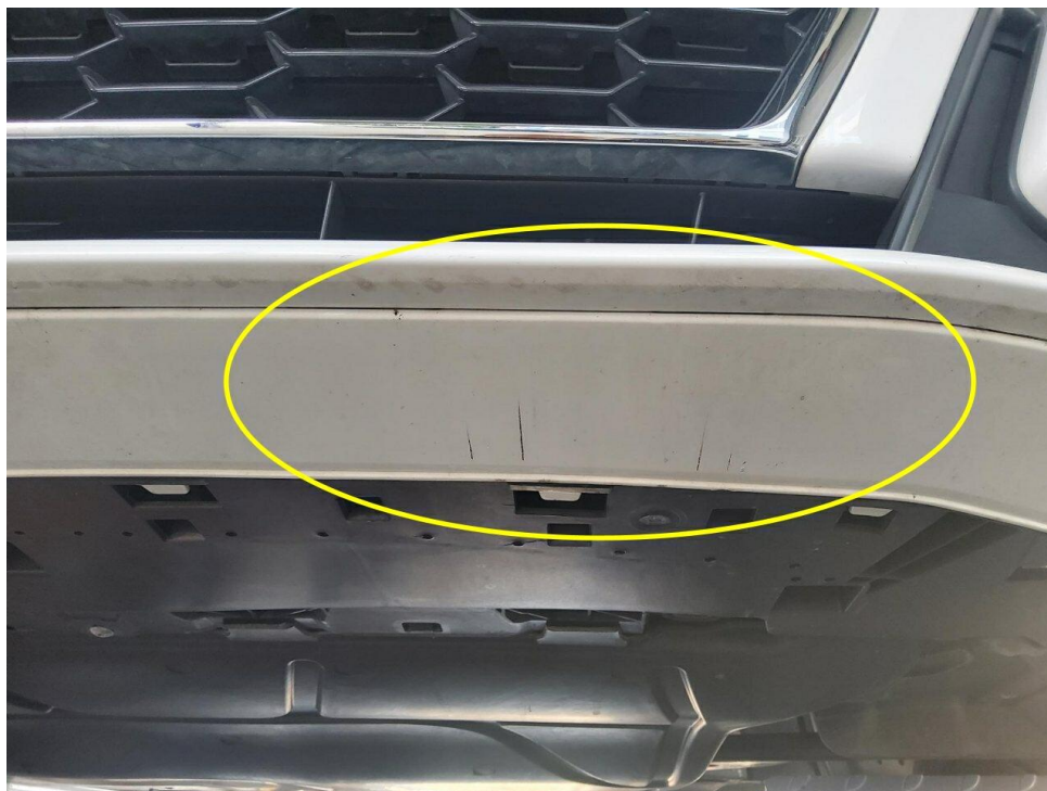
Bild 17 : Frontspoiler Lackierung, zerkratzt, lackieren mit Lackaufbau
