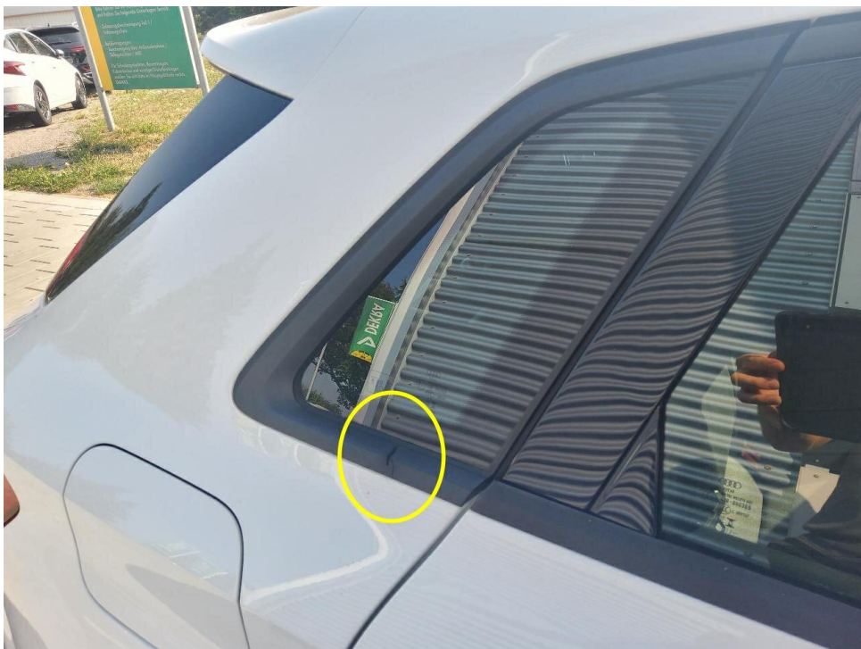
Bild 20 : Seitenscheibe hinten rechts, beschädigt
