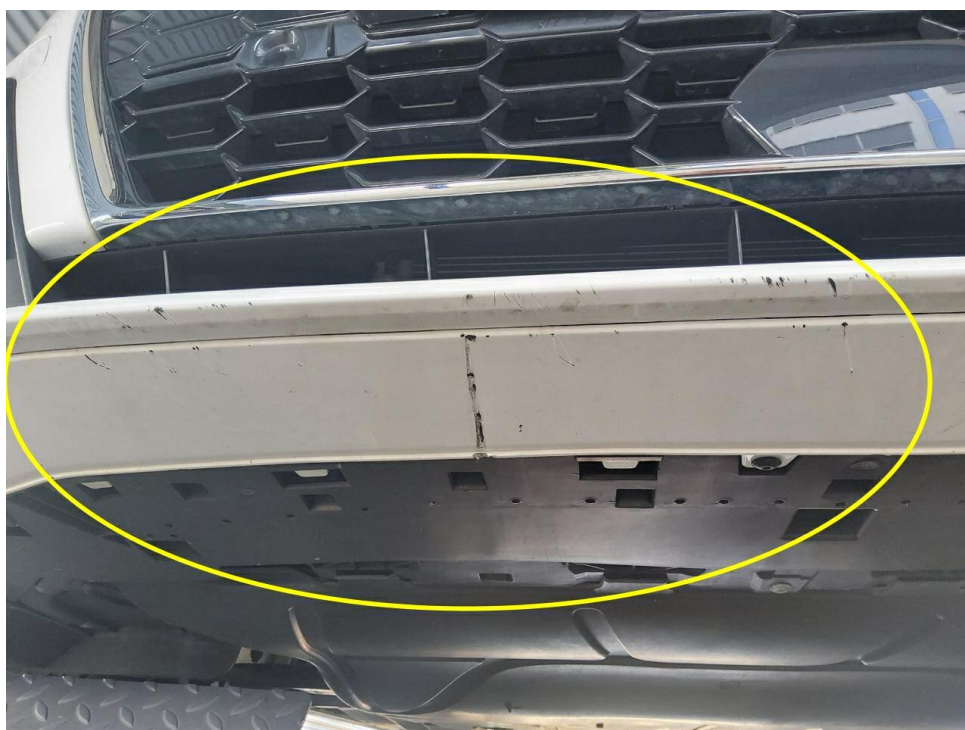
Bild 18 : Frontspoiler Lackierung, zerkratzt, lackieren mit Lackaufbau
