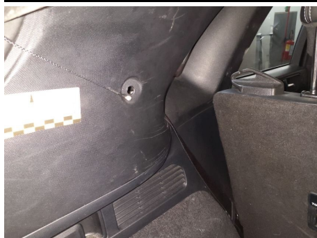
Gancio ripiano cappelliera / Posteriore Sinistro / Rotto
