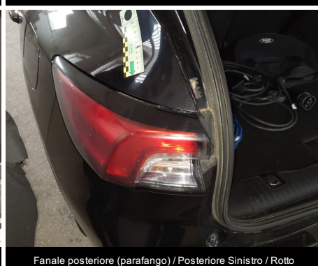
Fanale posteriore (parafango) / Posteriore Sinistro / Rotto
