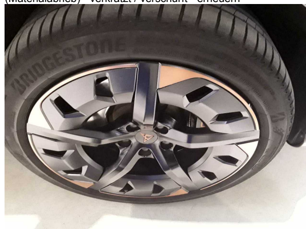
Beschädigung #2: Rad/Reifen: Leichtmetallfelge vorn rechts (Materialabrieb) - verkratzt / verschürft - erneuern
