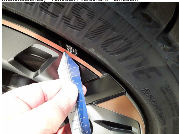
Beschädigung #1: Rad/Reifen: Leichtmetallfelge vorn links (Materialabrieb) - verkratzt / verschürft - erneuern
