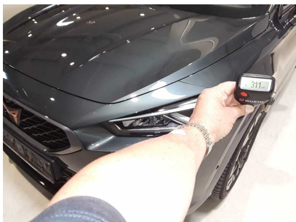
Nachlackierung 1: Kotflügel links, Stoßfänger hinten, Tür hinten rechts
