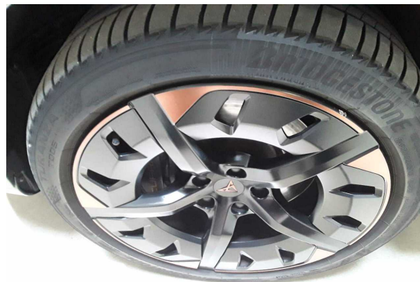
Beschädigung #1: Rad/Reifen: Leichtmetallfelge vorn links (Materialabrieb) - verkratzt / verschürft - erneuern
