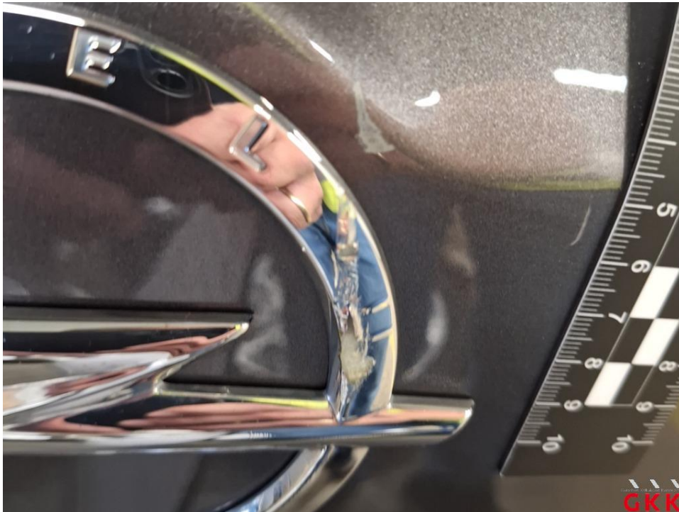
Bild 23 Heckklappe, Emblem, beschädigt, ersetzen
