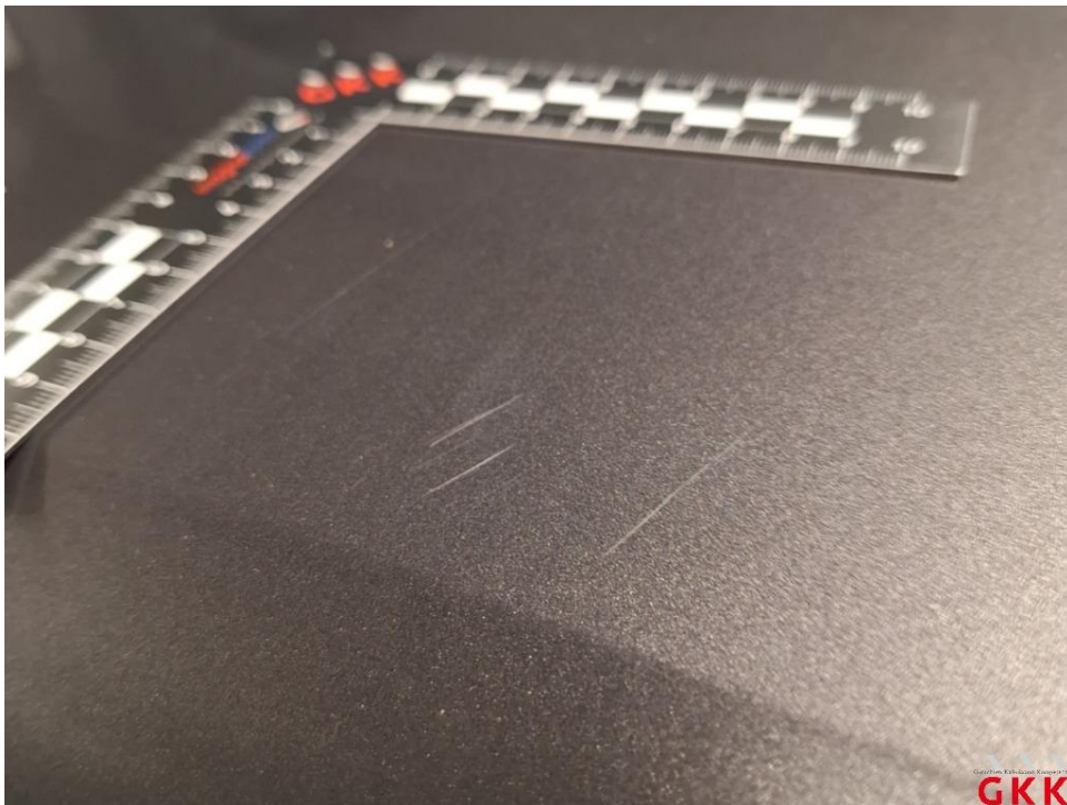
Bild 18 Dach, verkratzt, lackieren
