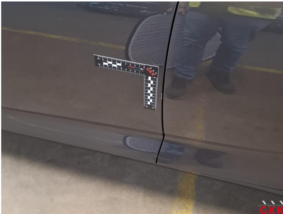
Bild 26 Tür vorne links, Kante, verkratzt, auslegen, schleifen, polieren
