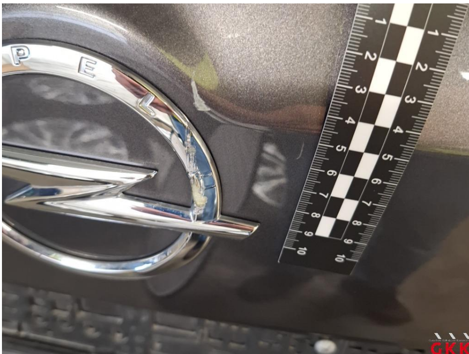
Bild 22 Heckklappe, Emblem, beschädigt, ersetzen
