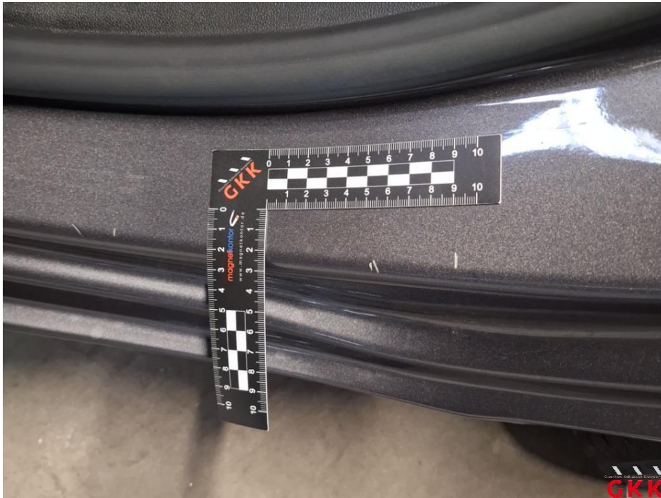
Bild 25 Tür hinten links, Einstieg, verkratzt, Smartrepair
