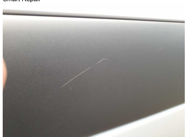
Beschädigung #9: Schiebetür rechts: Schutzleiste - Kratzer - erneuern
