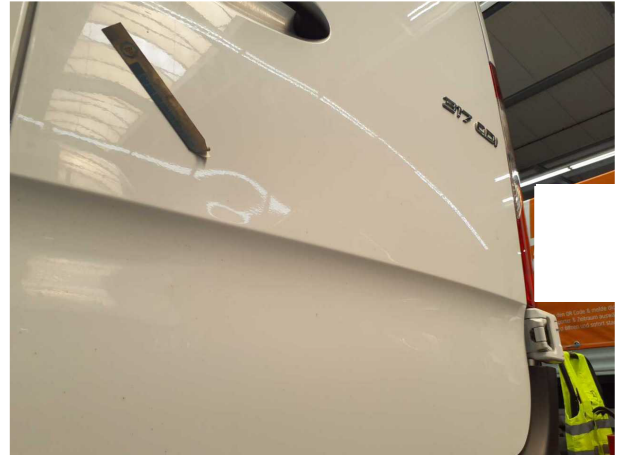
Beschädigung #7: Heckklappe/-tür: Hecktür rechts - Delle(n) - Smart Repair
