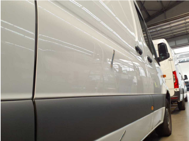
Beschädigung #19: Schiebetür rechts: Schiebetür - beschädigt - erneuern
