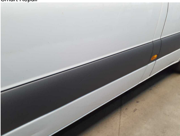
Beschädigung #9: Schiebetür rechts: Schutzleiste - Kratzer - erneuern
