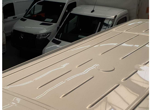
Beschädigung #2: Fahrzeugdach: Dach - Delle(n) - Smart Repair
