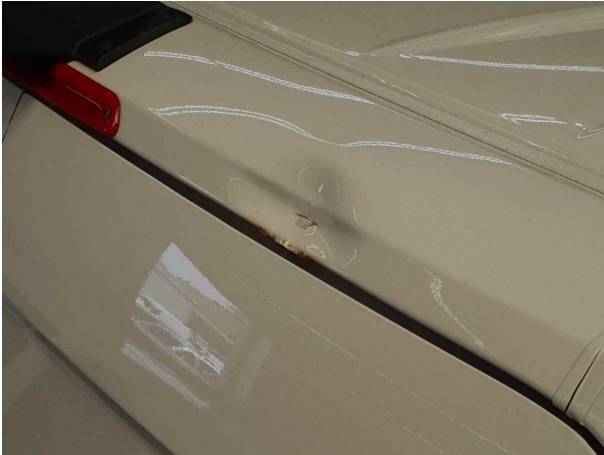
Beschädigung #18: Fahrzeugdach: Dach (D Teil) - beschädigt - erneuern
