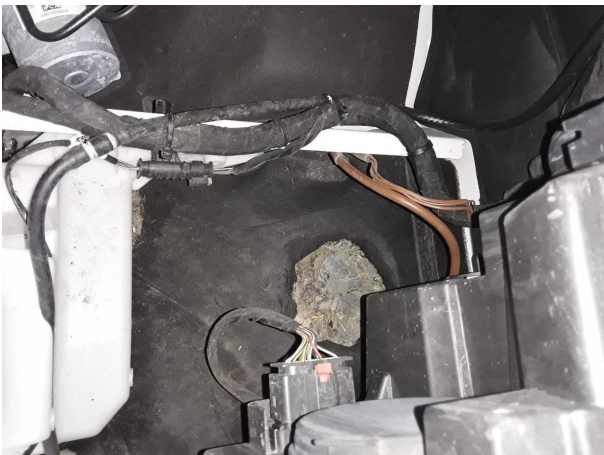
Beschädigung #5: Kotflügel links: Innenkotflügel - Marderschaden - erneuern
