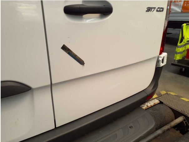
Beschädigung #7: Heckklappe/-tür: Hecktür rechts - Delle(n) - Smart Repair
