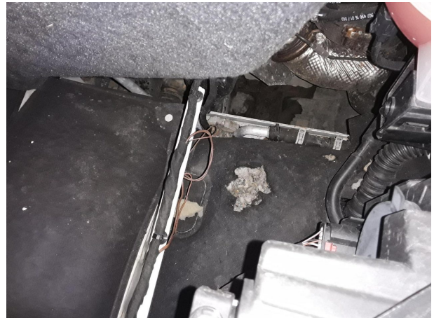
Beschädigung #4: Kotflügel rechts: Innenkotflügel - Marderschaden - erneuern
