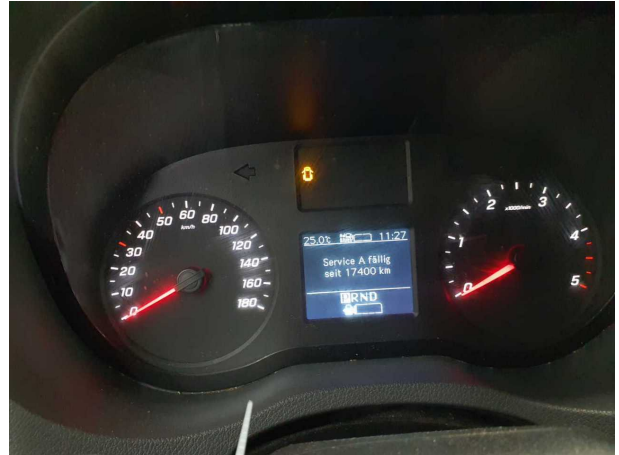
Beschädigung #13: Sonstiges: Inspektion/Wartung - fällig - durchführen
