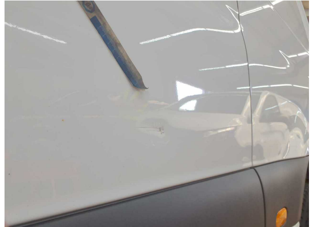
Beschädigung #14: Seitenwand links: Seitenwand (vorn) - Delle / Lackschaden - instandsetzen und lackieren
