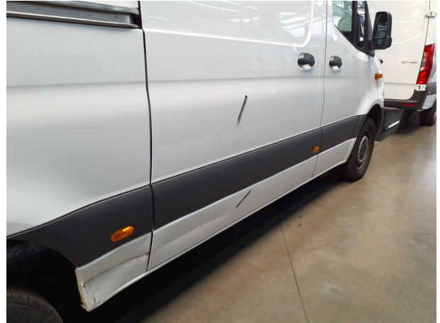
Beschädigung #19: Schiebetür rechts: Schiebetür - beschädigt - erneuern
