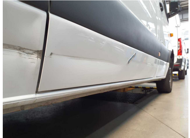
Beschädigung #19: Schiebetür rechts: Schiebetür - beschädigt - erneuern
