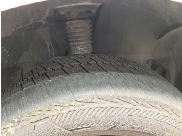
Beschädigung #11: Rad/Reifen: Reifen vorn rechts - verschlissen - erneuern
