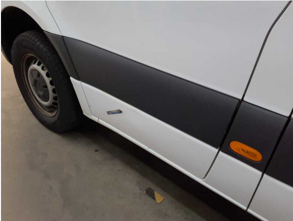
Beschädigung #10: Tür vorn links: Tür - Delle(n) - instandsetzen und lackieren
