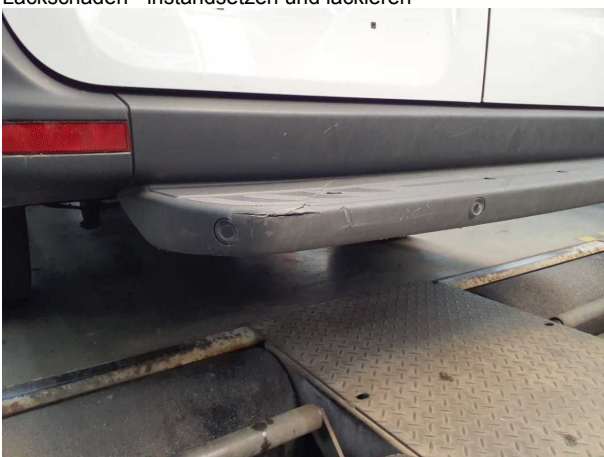
Beschädigung #15: Stossfänger hinten: Stossfänger Auftritt mit Parktronic (komplett) - beschädigt - erneuern
