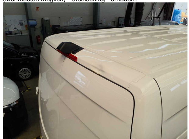
Beschädigung #18: Fahrzeugdach: Dach (D Teil) - beschädigt - erneuern
