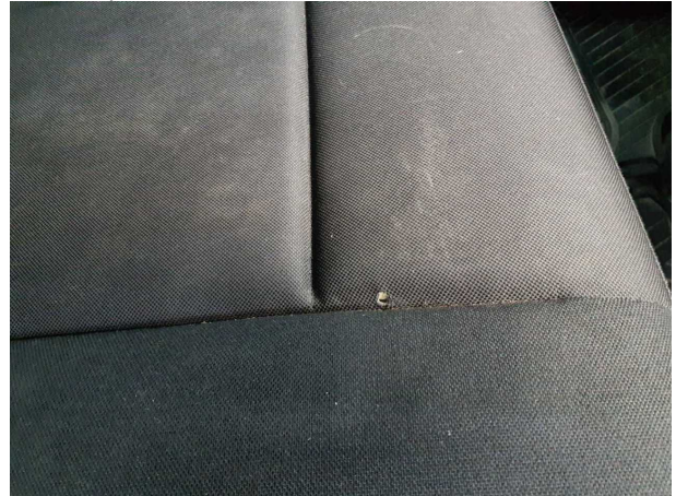
Beschädigung #8: Sitz vorn: Sitzbezug rechts (2er) - Brandloch - Smart Repair
