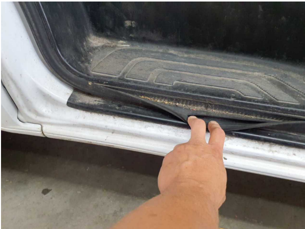
Beschädigung #3: Tür vorn links: Türdichtung - beschädigt - erneuern
