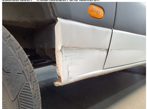
Beschädigung #16: Seitenwand rechts: Seitenwand (v.u., inkl. Innenteil Instandsetzen) - beschädigt - erneuern
