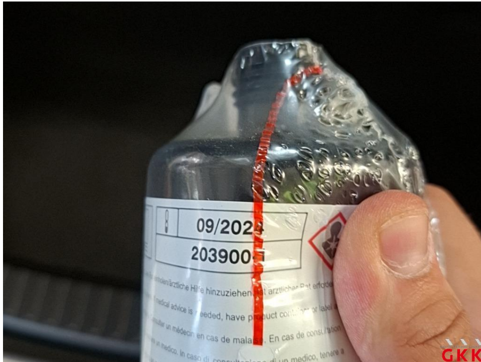
Bild 13 Reifenreparaturset, Füllflasche, MHD überschritten, ersetzen
