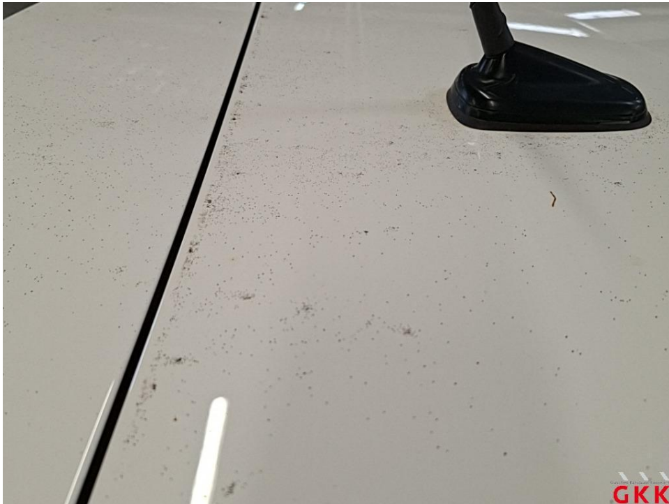
Bild 19 Fahrzeug, außen, Lackierung verwittert / matt, aufbereiten
