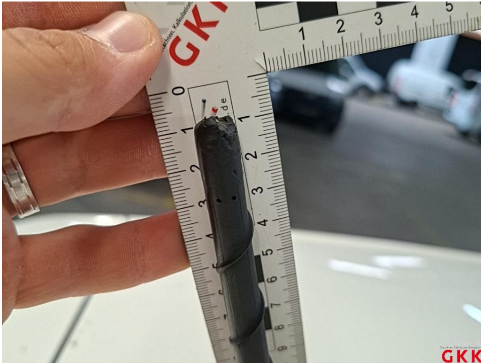
Bild 23 Antenne, Stab, beschädigt, ersetzen
