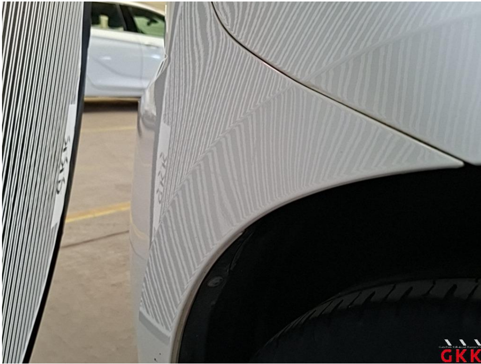
Bild 27 Stoßfänger hinten, Verkleidung -lackiert-, beschädigt, ersetzen
