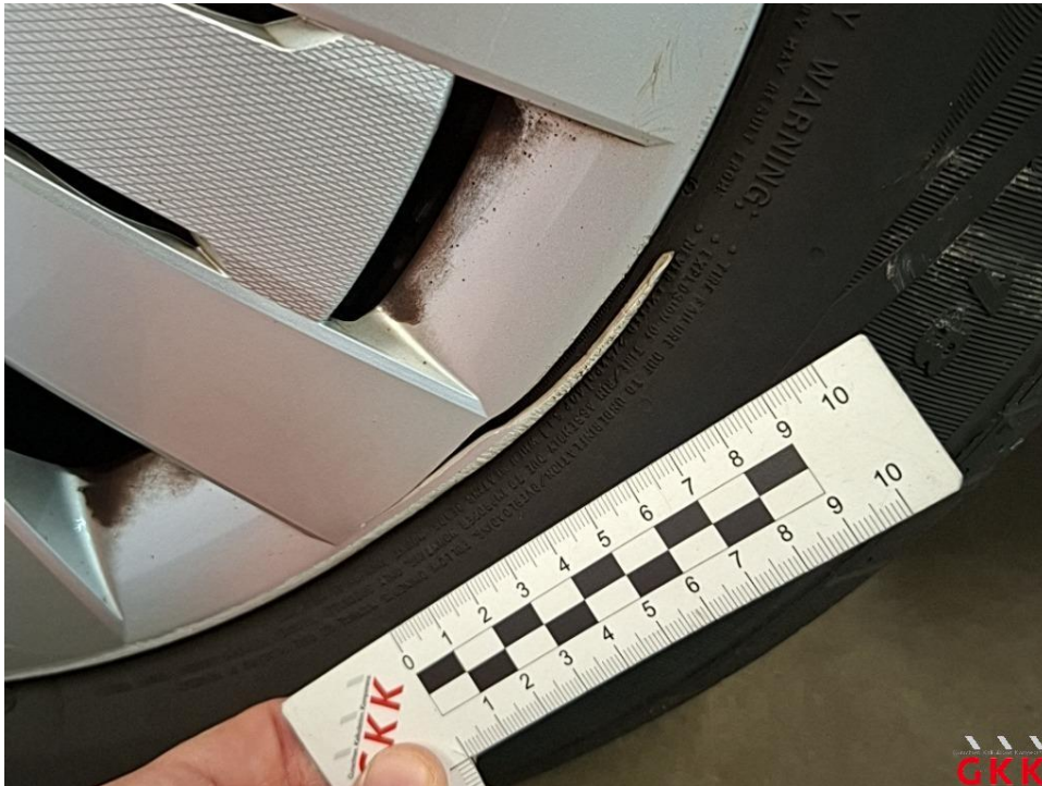
Bild 21 Radkappe(n), vorne rechts, beschädigt, ersetzen
