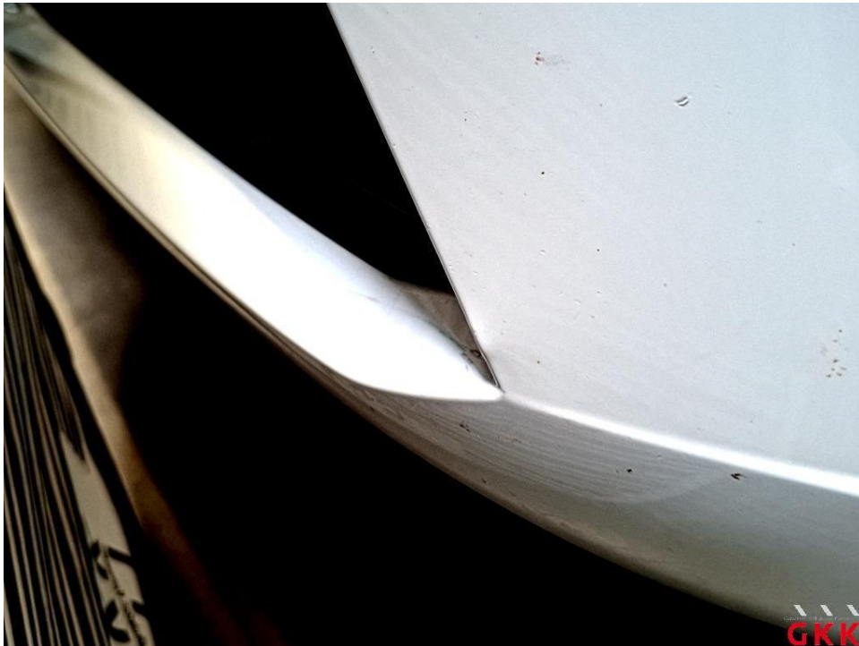
Bild 15 Stoßfänger vorne, Verkleidung -lackiert-, beschädigt, ersetzen
