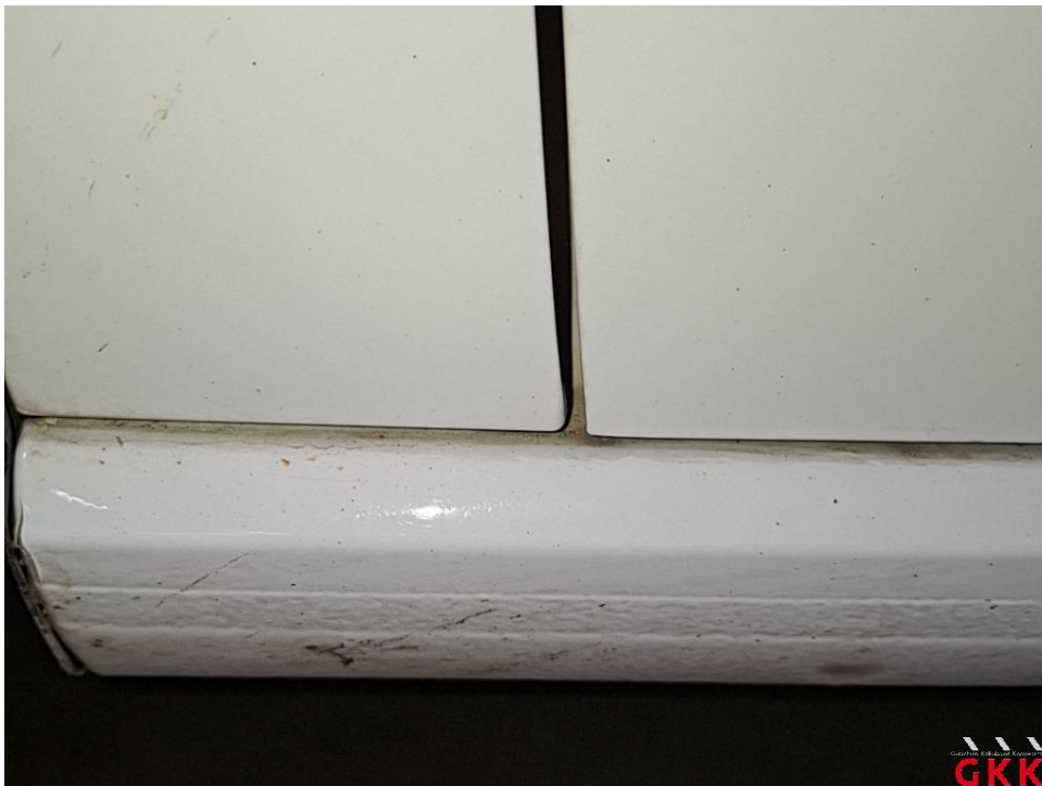
Bild 18 Fahrzeug, außen, Lackierung verwittert / matt, aufbereiten
