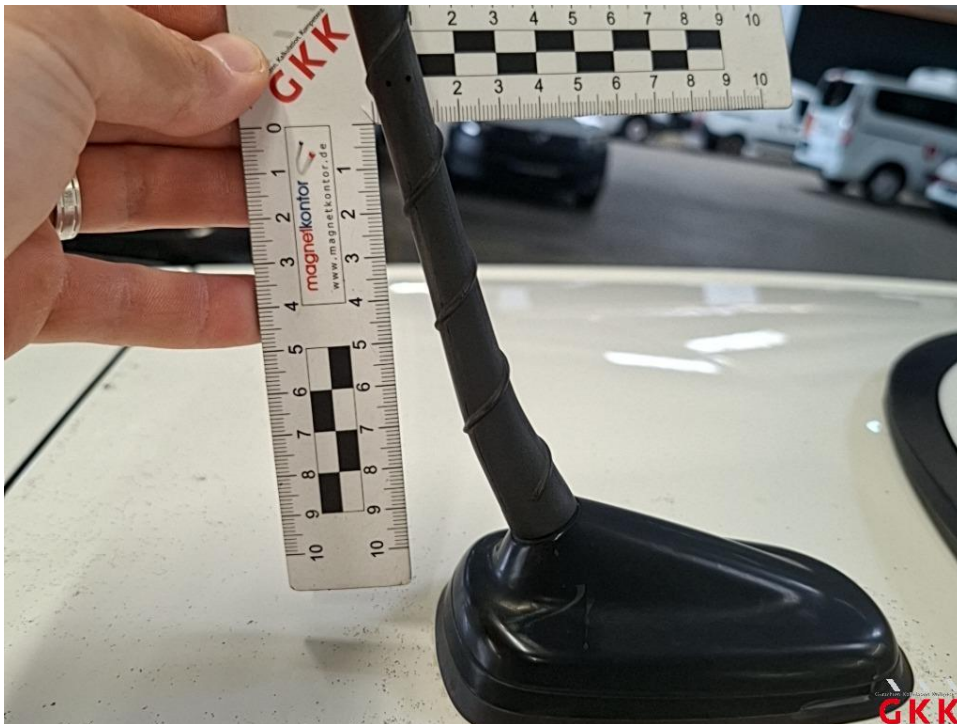
Bild 24 Antenne, Stab, beschädigt, ersetzen
