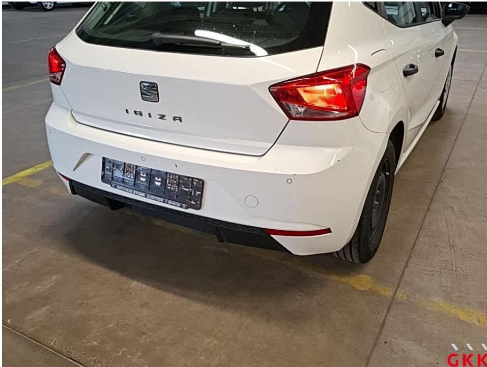
Bild 25 Stoßfänger hinten, Verkleidung -lackiert-, beschädigt, ersetzen
