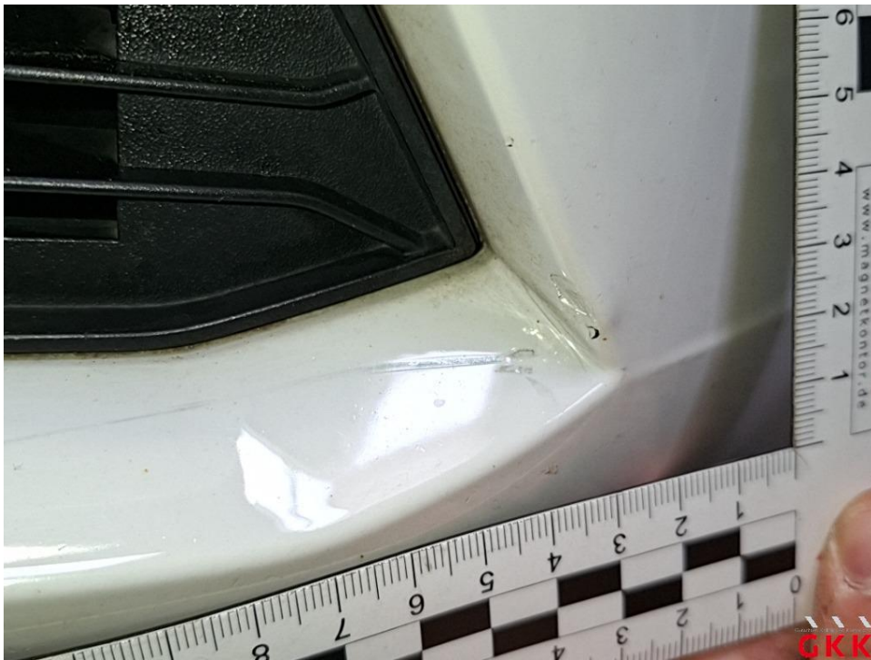
Bild 16 Stoßfänger vorne, Verkleidung -lackiert-, beschädigt, ersetzen
