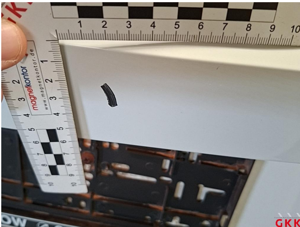
Bild 26 Stoßfänger hinten, Verkleidung -lackiert-, beschädigt, ersetzen
