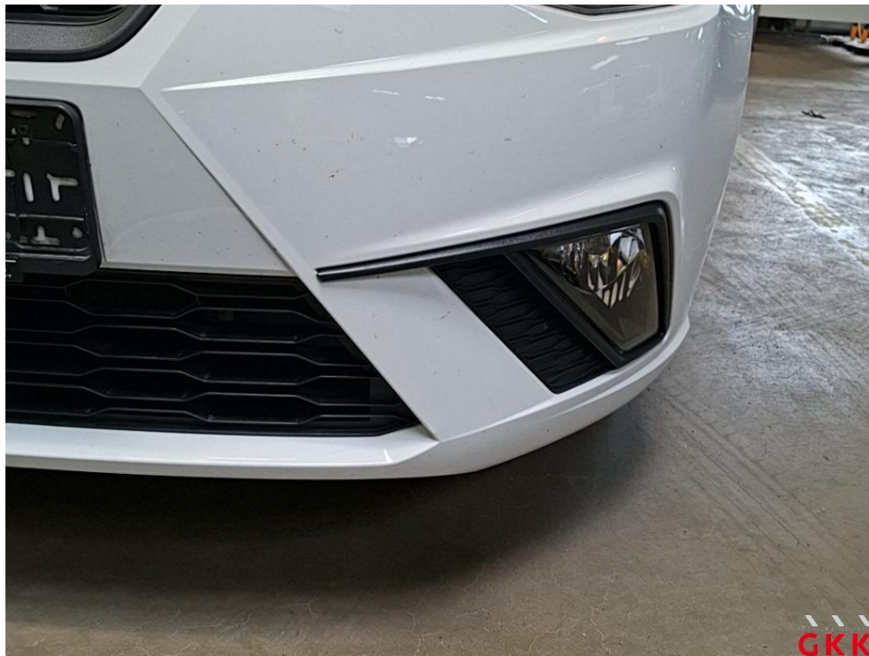
Bild 14 Stoßfänger vorne, Verkleidung -lackiert-, beschädigt, ersetzen
