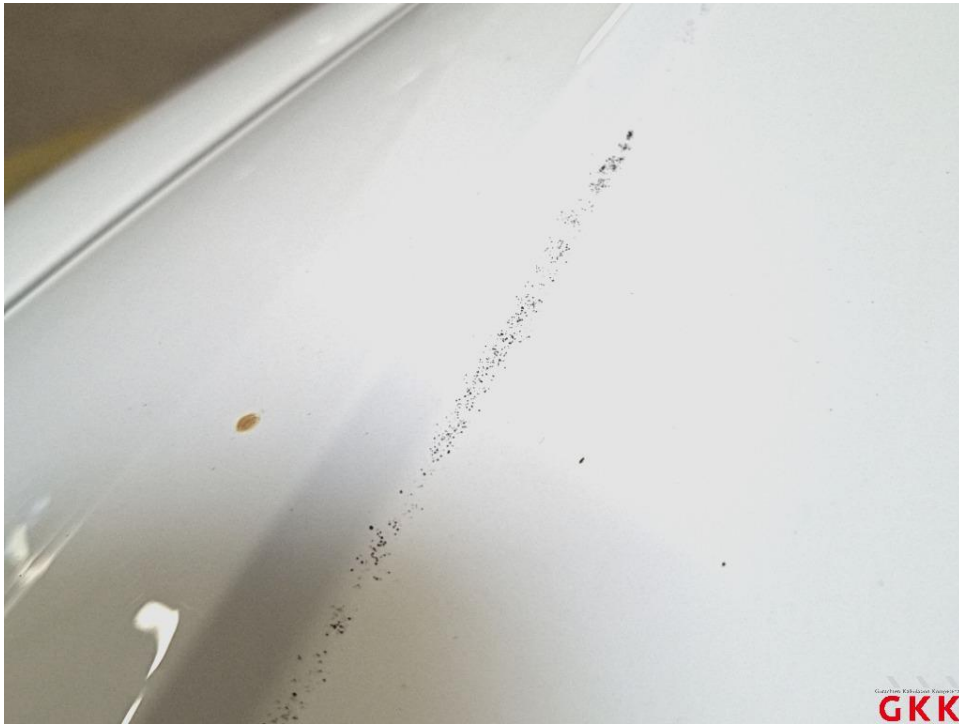
Bild 17 Fahrzeug, außen, Lackierung verwittert / matt, aufbereiten
