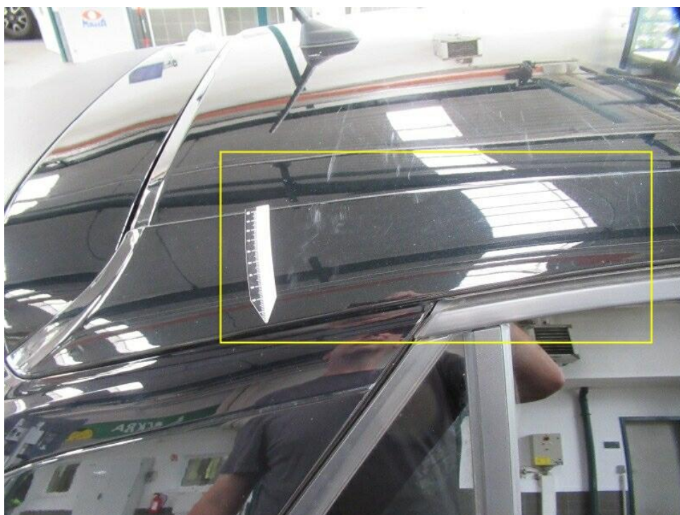
Bild 28 : Dachrahmen rechts Lackierung, zerkratzt, lackieren mit Lackaufbau
