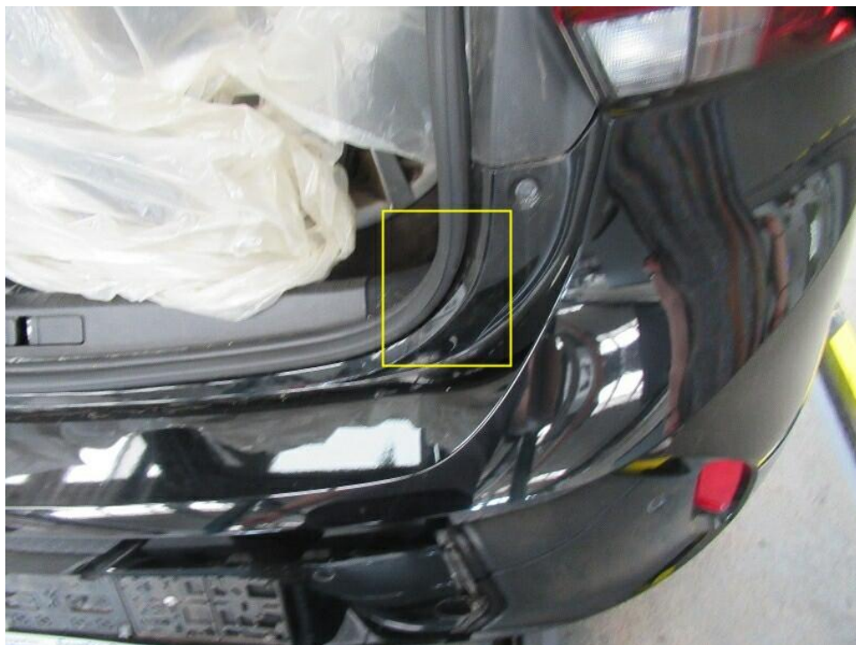
Bild 20 : Dichtung der Heckklappe gebrochen
