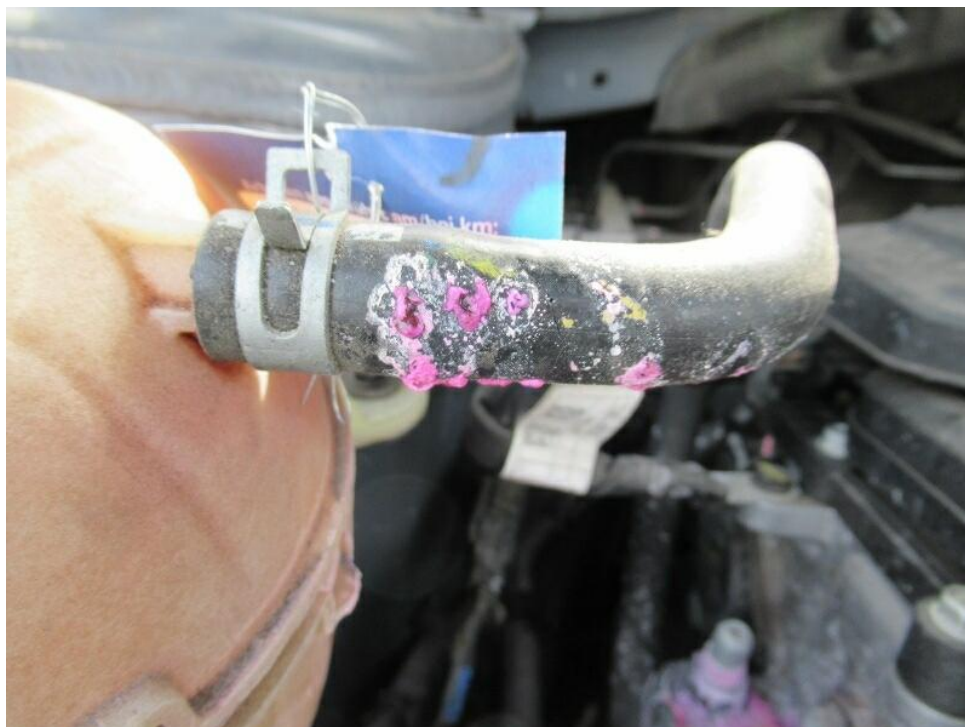
Bild 16 : Marderschaden im Motorraum
