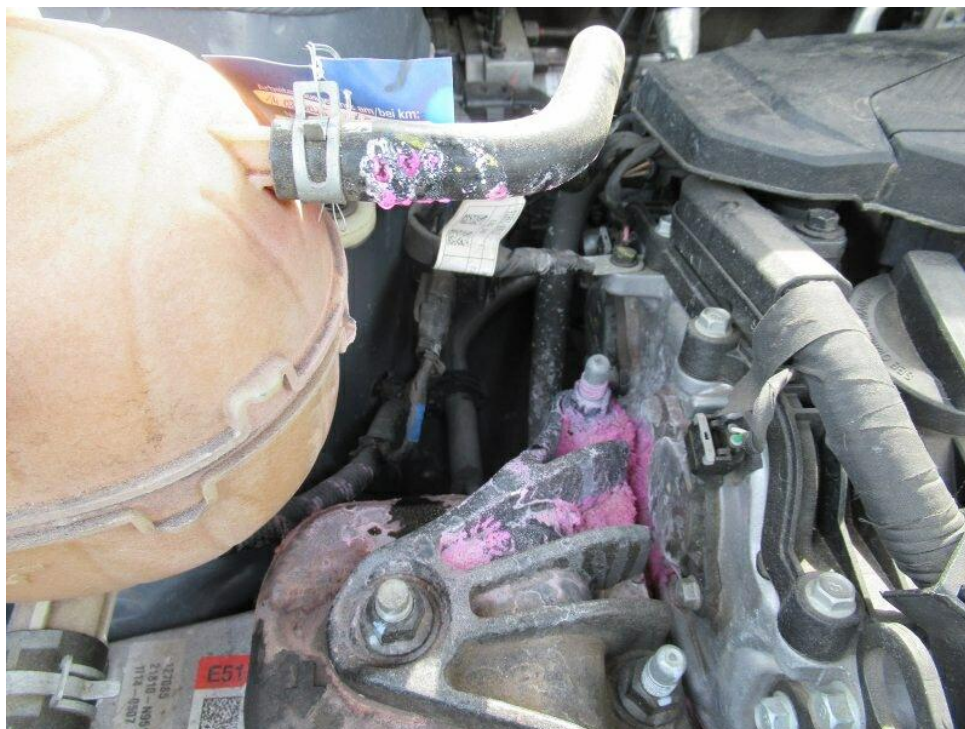
Bild 15 : Marderschaden im Motorraum
