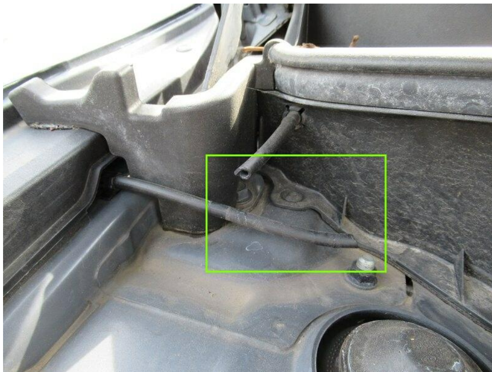
Bild 17 : Marderschaden im Motorraum
