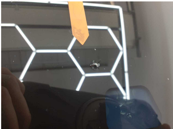
Beschädigung #5: Verglasung: Frontscheibe - Steinschlag - erneuern
