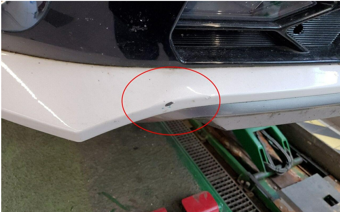
Bild 9 : Stoßfängerverkleidung vorne, deformiert
