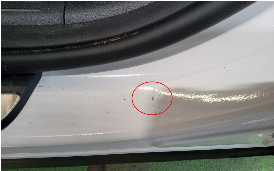
Bild 7 : Tür vorne links, Einstieg zerkratzt
