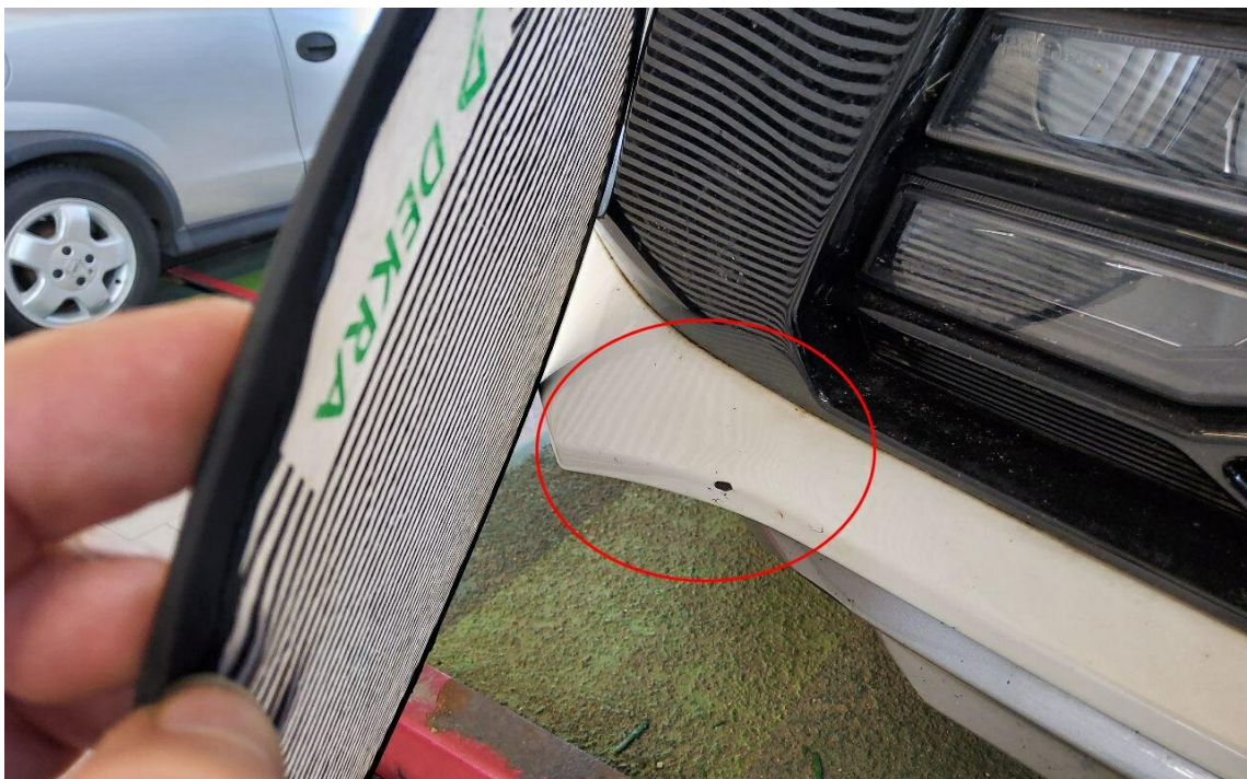
Bild 10 : Stoßfängerverkleidung vorne, deformiert
