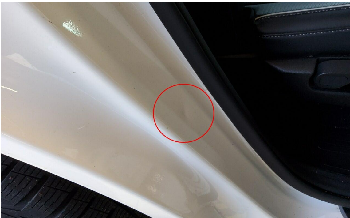
Bild 8 : Tür hinten rechts, Einstieg eingedellt
