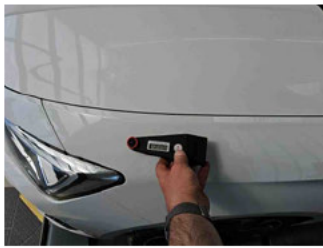
Lackstärke Kotflügel vorne links
