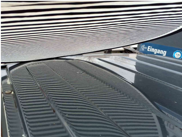
Beschädigung #2: Karosserie: Karosserie (Separates Hagelgutachten durch Versicherung erforderlich.) - Hagelschaden
