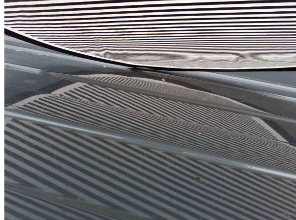
Beschädigung #2: Karosserie: Karosserie (Separates Hagelgutachten durch Versicherung erforderlich.) -
