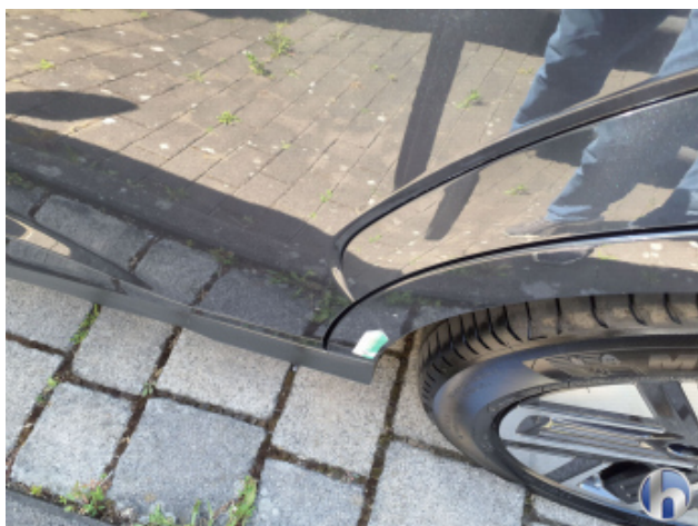
4. Seitenwand - Hinten - Links Kratzer - Smart Repair
