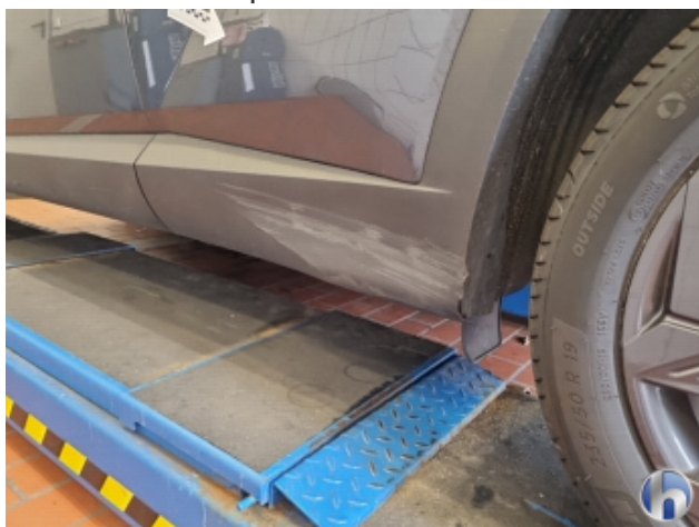
2. Tür Hinten - Links Beschädigt - Siehe Kalkulation
