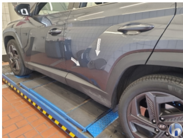
2. Tür Hinten - Links Beschädigt - Siehe Kalkulation
