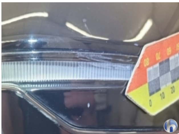
7. Außenspiegel Beheizt Blinker - Rechts Beschädigt - Erneuern
