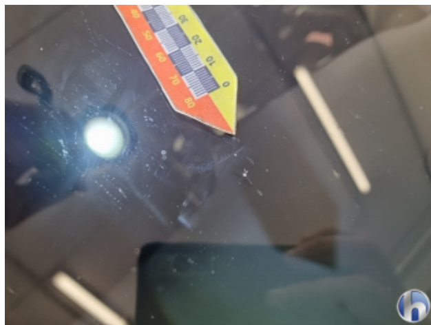
4. Windschutzscheibe Riss - Erneuern
