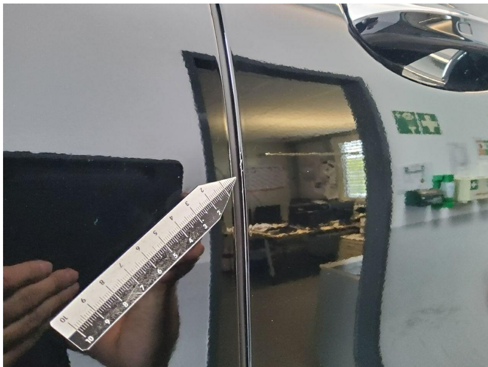
Bild 8 : Tür vorn rechts, Türkante verschrammt
