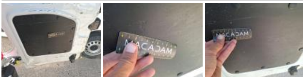
Boot door lining R, Scratch(es), Replace
