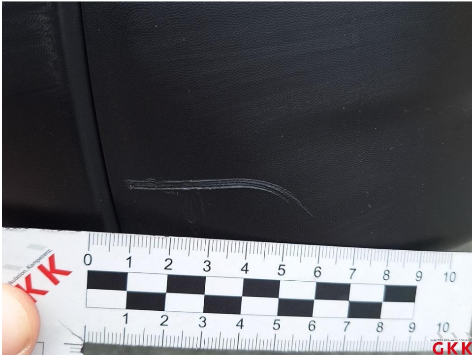
Bild 32. Stoßfänger hinten, Verkleidung -unlackiert-, verkratzt, Smartrepair
