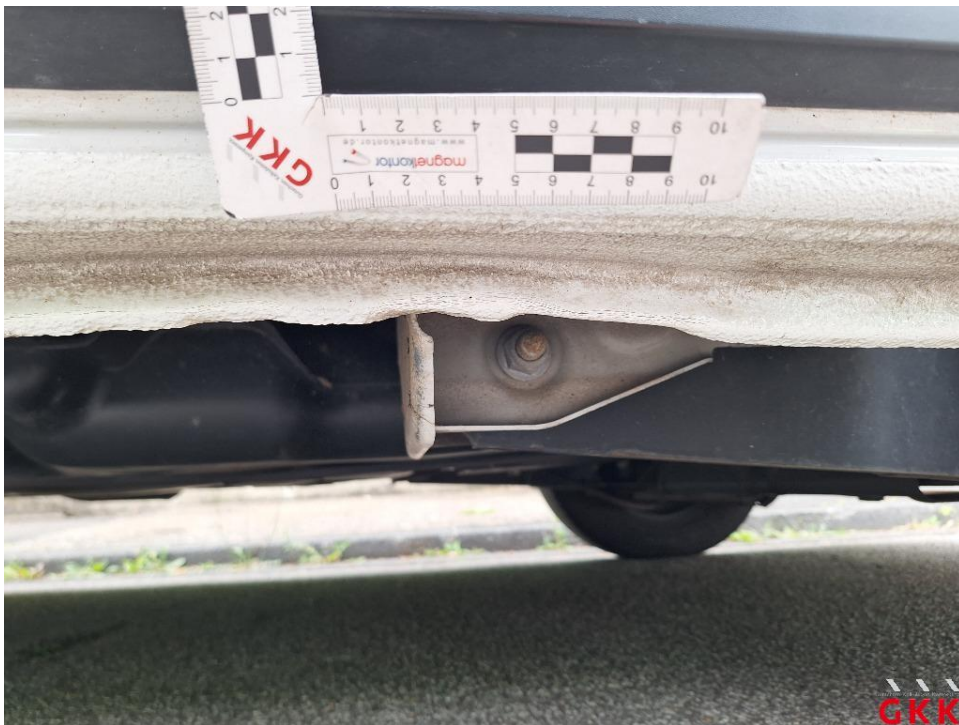
Bild 34. Schweller links, beschädigt, instand setzen - lackieren
