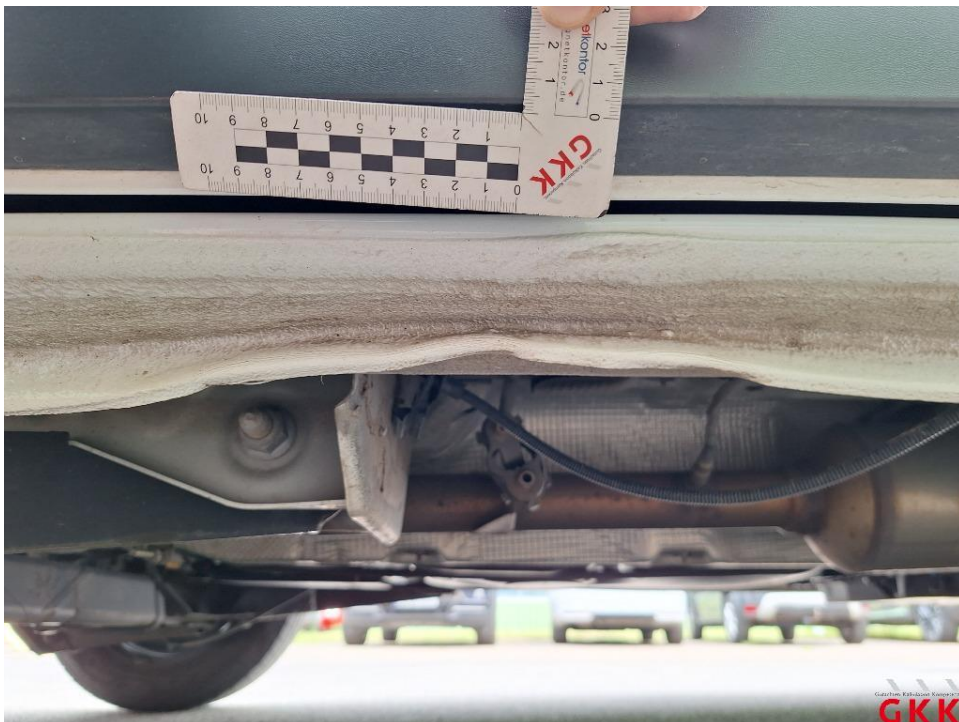
Bild 24. Schweller rechts, beschädigt, instand setzen - lackieren
