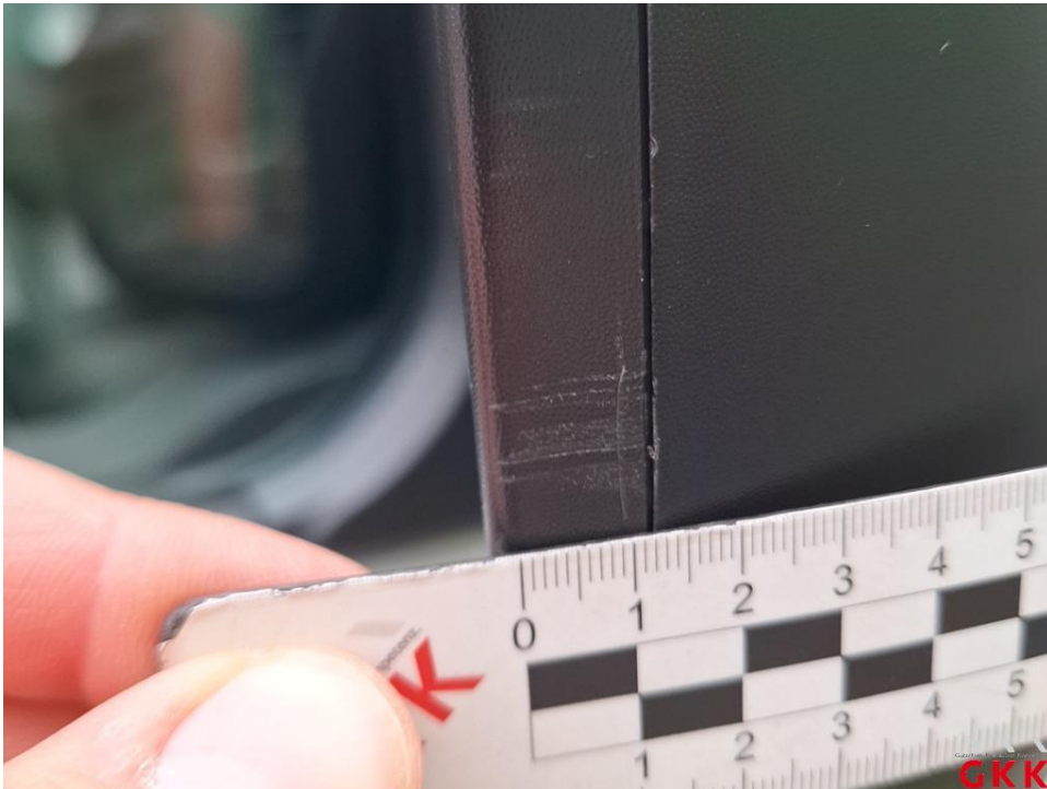
Bild 22. Spiegelgehäuse rechts, Rahmen, verkratzt, Smartrepair
