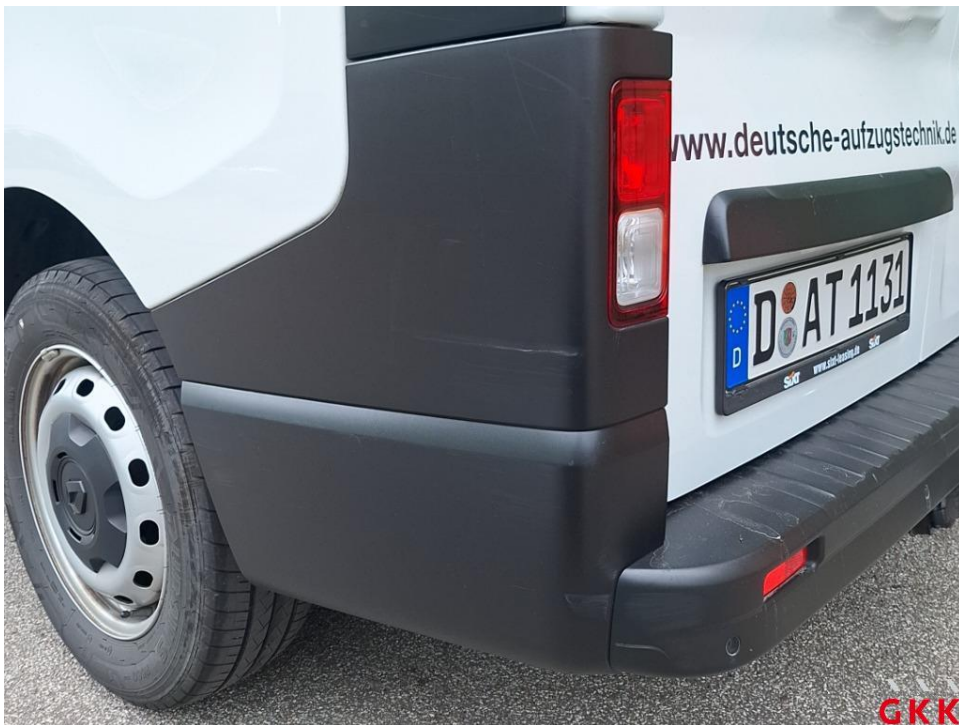
Bild 28. Stoßfänger hinten, Ecke links -unlackiert-, verkratzt, Smartrepair
