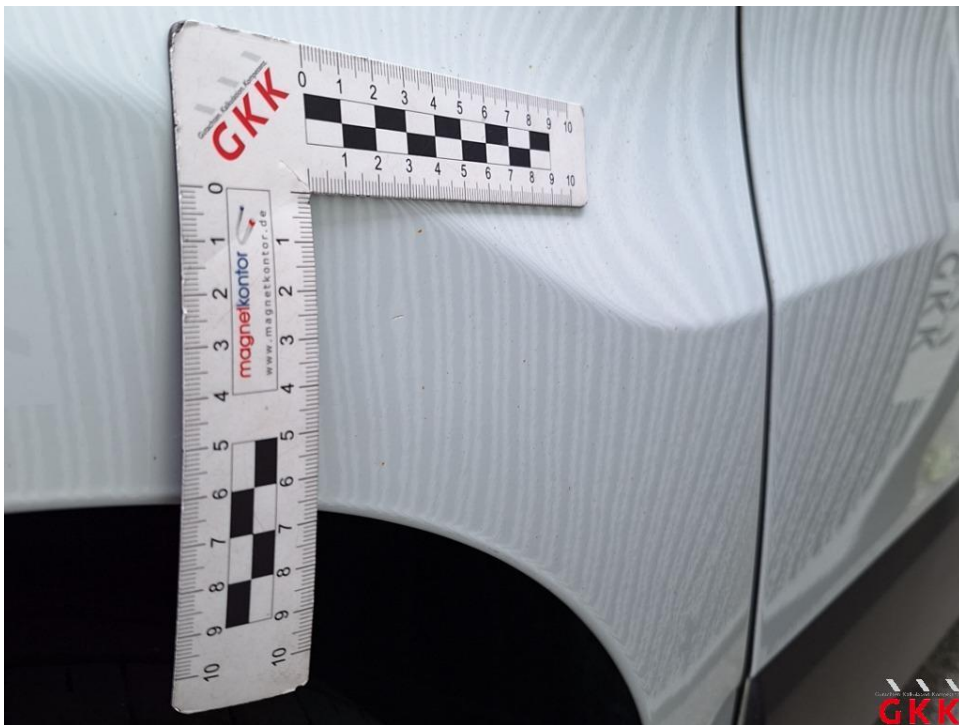
Bild 26. Seitenwand rechts, bis 3 Dellen / Bauteil, kalt drücken
