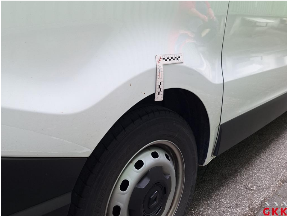
Bild 25. Seitenwand rechts, bis 3 Dellen / Bauteil, kalt drücken
