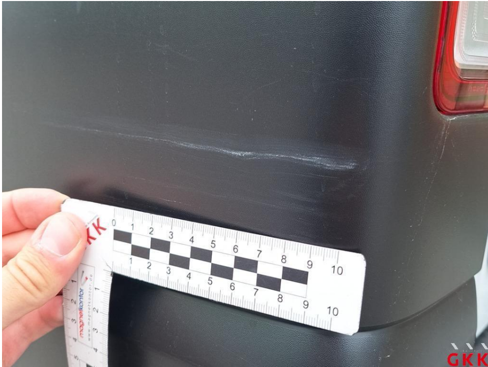
Bild 29. Stoßfänger hinten, Ecke links -unlackiert-, verkratzt, Smartrepair
