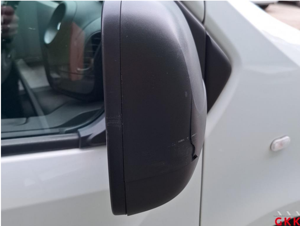
Bild 21. Spiegelgehäuse rechts, Rahmen, verkratzt, Smartrepair
