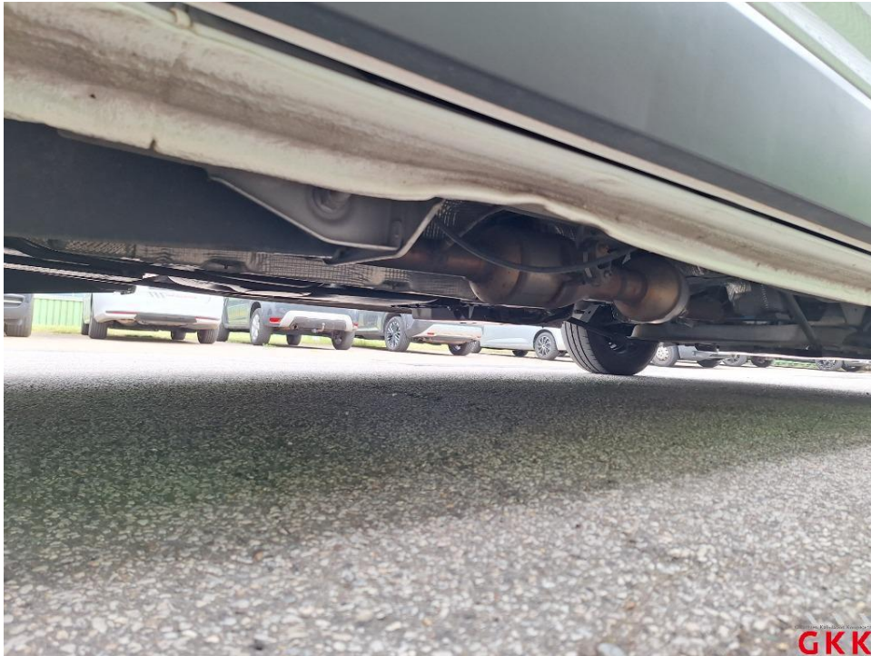
Bild 23. Schweller rechts, beschädigt, instand setzen - lackieren
