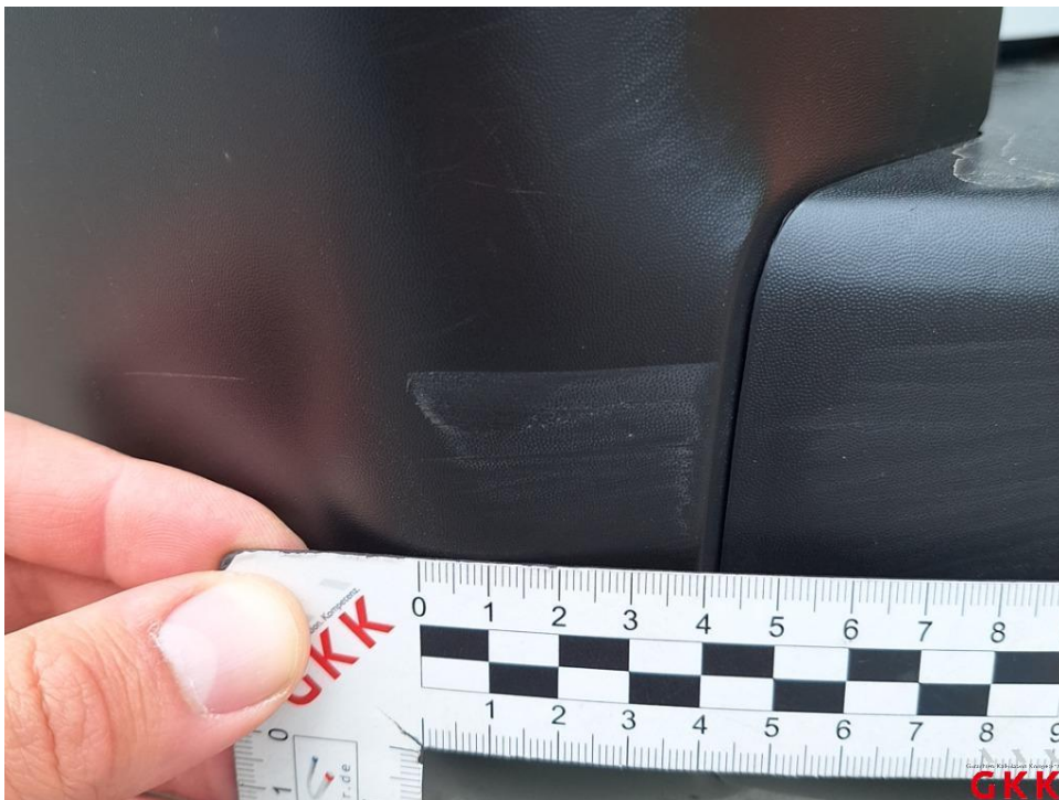
Bild 30. Stoßfänger hinten, Ecke links -unlackiert-, verkratzt, Smartrepair
