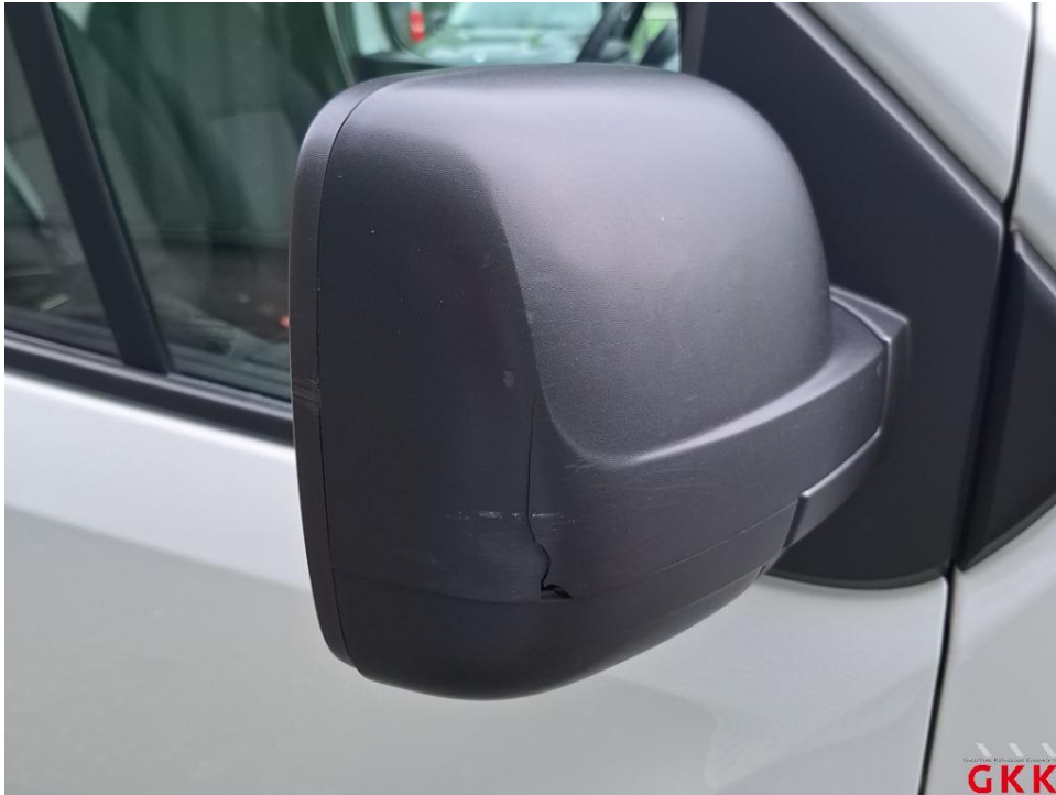
Bild 19. Spiegelgehäuse rechts, Kappe -unlackiert-, gerissen, ersetzen
