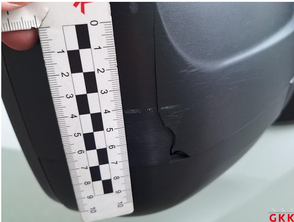
Bild 20. Spiegelgehäuse rechts, Kappe -unlackiert-, gerissen, ersetzen
