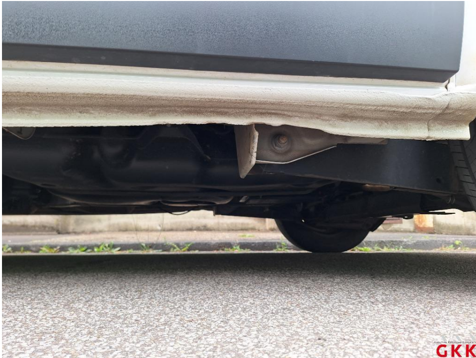
Bild 33. Schweller links, beschädigt, instand setzen - lackieren
