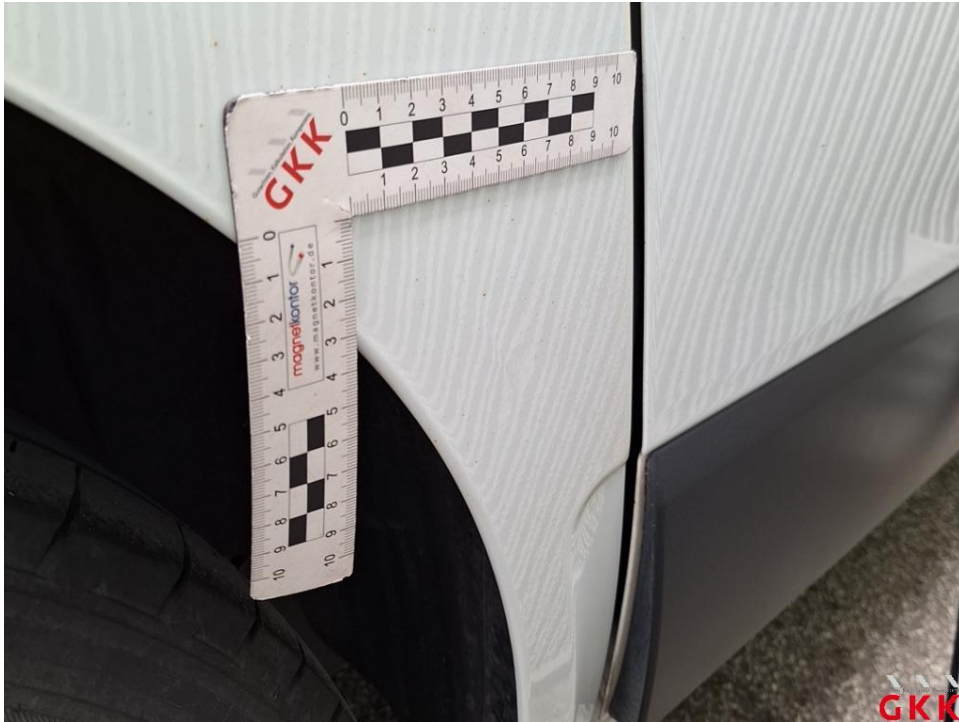
Bild 27. Seitenwand rechts, bis 3 Dellen / Bauteil, kalt drücken
