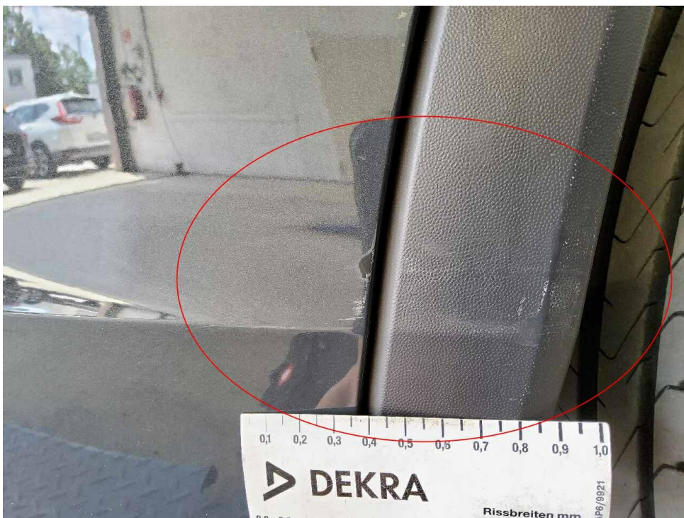
Bild 16 : Spoiler Stoßfänger hinten, Lackierung, verschrammt Radlaufblende hinten rechts, verschrammt
