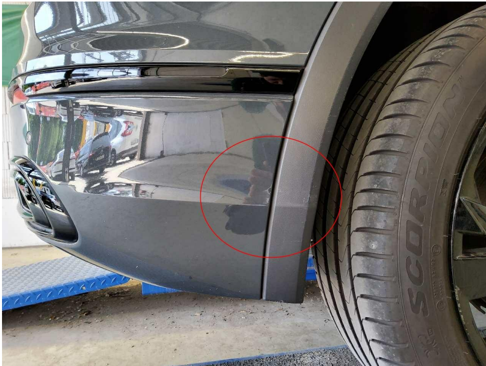
Bild 15 : Spoiler Stoßfänger hinten, Lackierung, verschrammt Radlaufblende hinten rechts, verschrammt
