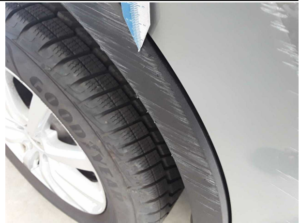
Beschädigung #4: Seitenwand rechts: Radhausverbreiterun... verkratzt / verschürft - erneuern
