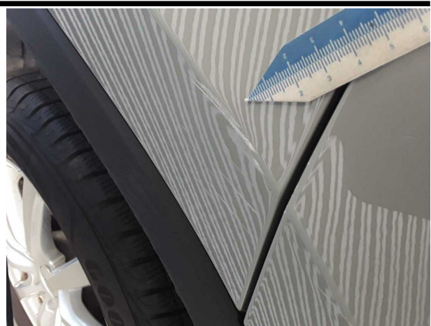
Beschädigung #9: Seitenwand rechts: Seitenwand - verkratzt / verschürft - instandsetzen und lackieren
