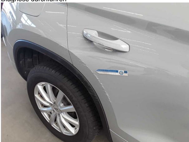
Beschädigung #7: Tür hinten rechts: Tür - verkratzt / verschürft - instandsetzen und lackieren
