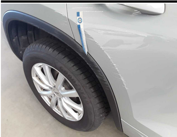
Beschädigung #4: Seitenwand rechts: Radhausverbreiterung - verkratzt / verschürft - erneuern
