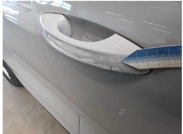
Beschädigung #2: Tür vorn rechts: Griff außen - verkratzt / verschürft - instandsetzen und lackieren
