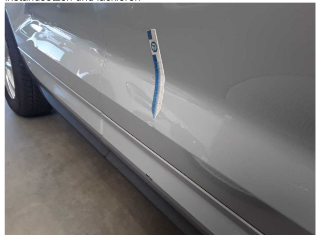
Beschädigung #8: Tür vorn rechts: Tür - Delle / Lackschade... instandsetzen und lackieren
