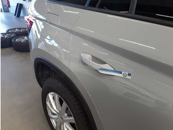
Beschädigung #1: Tür hinten rechts: Griff außen - verkratzt / verschürft - instandsetzen und lackieren
