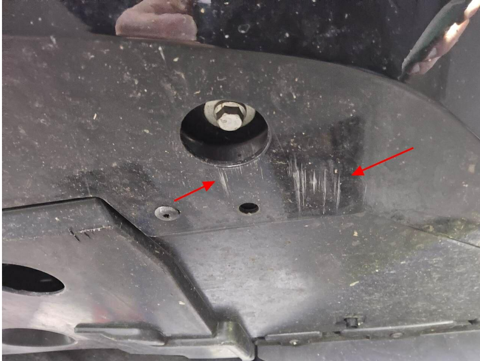
Bild 26 : Frontspoiler Lackierung, zerkratzt, lackieren mit Lackaufbau
