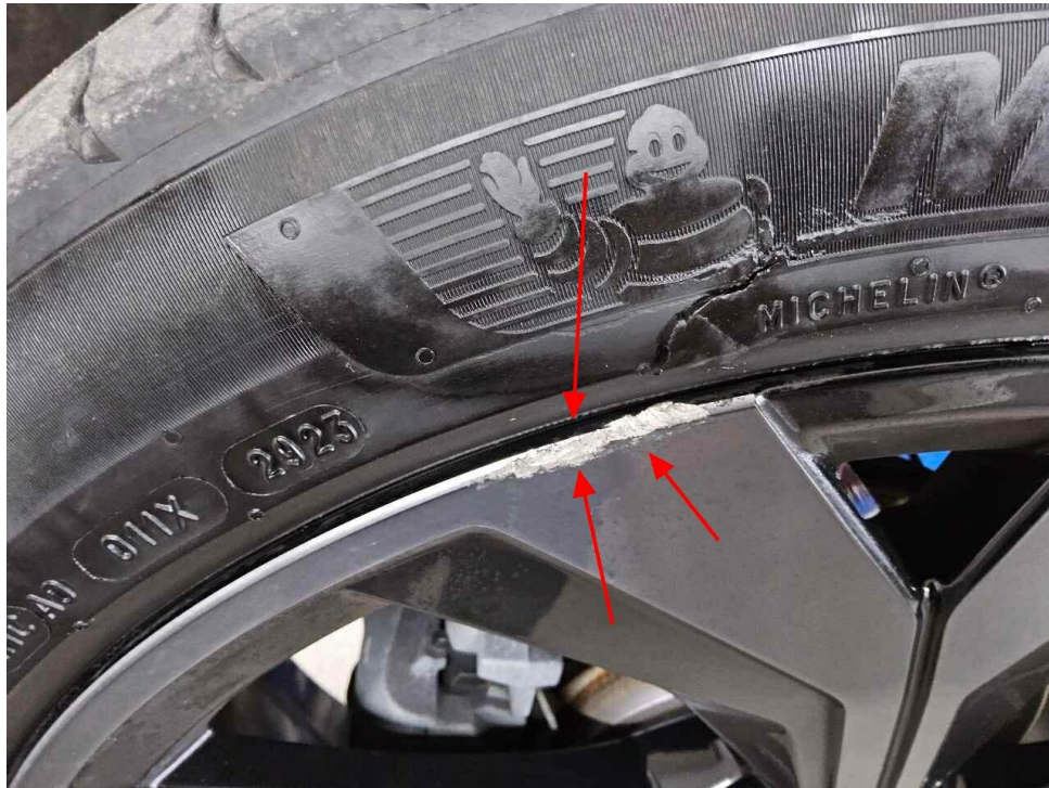
Bild 16 : Leichtmetallfelge vorne links verschrammt
