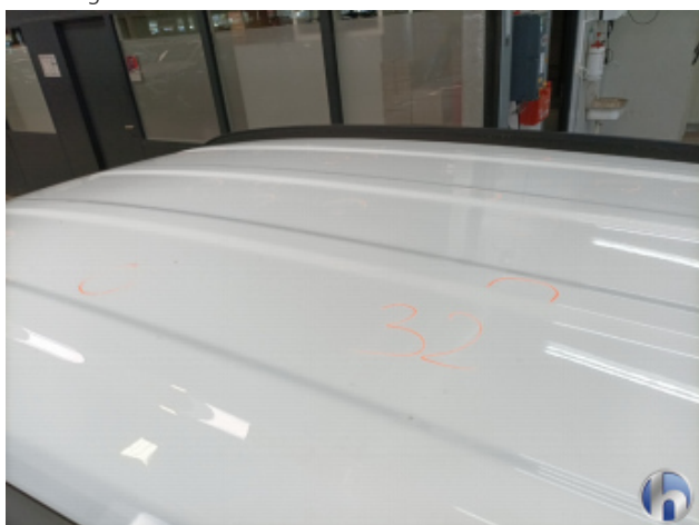
1. Dach Hagelschaden - Sanft Instandsetzen
